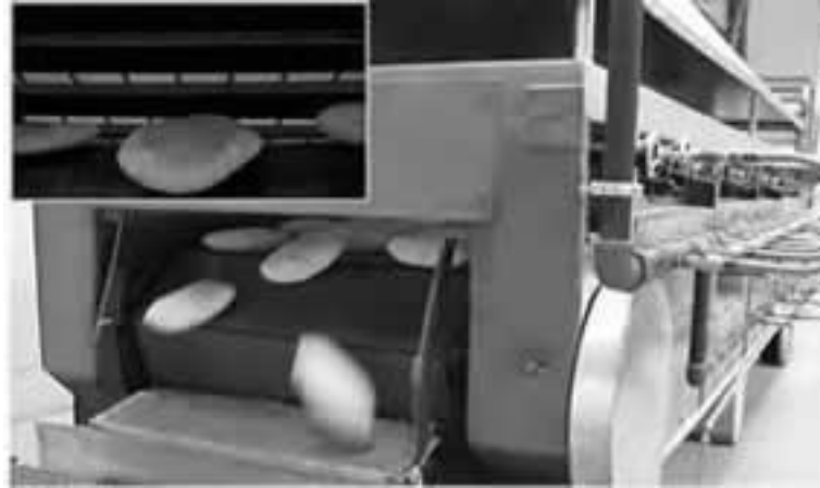
Figura 8. Equipo con quemadores infrarrojos para fabricar pan árabe 13
