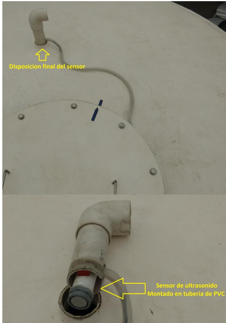
Figura 12. Fijación del sensor de distancia por ultrasonido.
