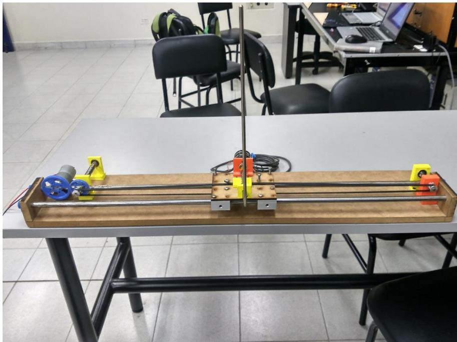
Figura 8 – Construcción de planta para péndulo invertido – Elaboración propia.
