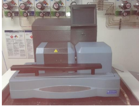
Figura 12. Analizar térmico TGA SDT Q600 acoplado con detector DSC.
