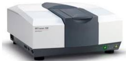
Figura 11. Espectrómetro infrarrojo Advantage FTIR 8400 SHIMADZU.
