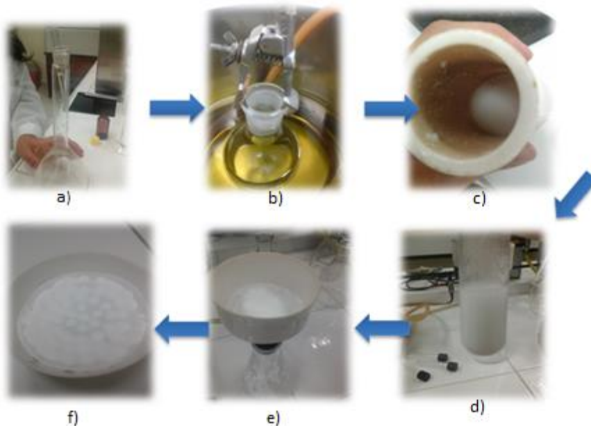
Figura 8. Síntesis SBA-15 por el método hidrotérmal, a) preparación de reactivos, b) calentamiento para hidrólisis y reacción, c) autoclave de teflón, d) gel final de síntesis, d) filtrado al vacío, e) muestra filtrada y seca.
