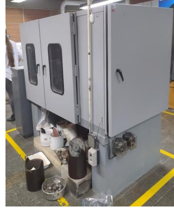
Figura 2-2: Equipos utilizados para la trituración y molienda de los residuos de placa de yeso. a) Trituradora de rodillos y b) Molino de bolas. Fuente: Elaboración propia.
