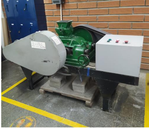
Figura 2-2: Equipos utilizados para la trituración y molienda de los residuos de placa de yeso. a) Trituradora de rodillos y b) Molino de bolas. Fuente: Elaboración propia.
