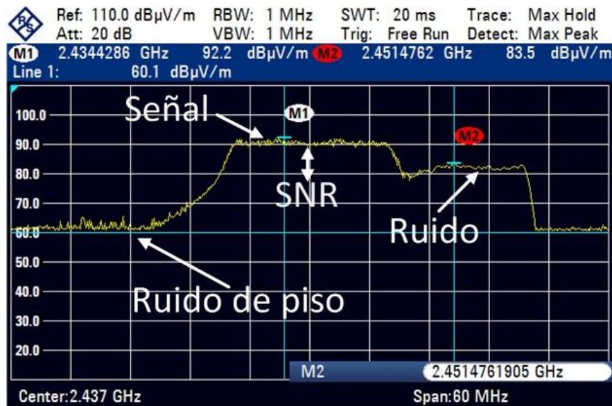
Figura 3-17. Medidas de SNR con fuente de ruido para 2437 MHz correspondiente al canal 6 de IEEE 802.11 g.
