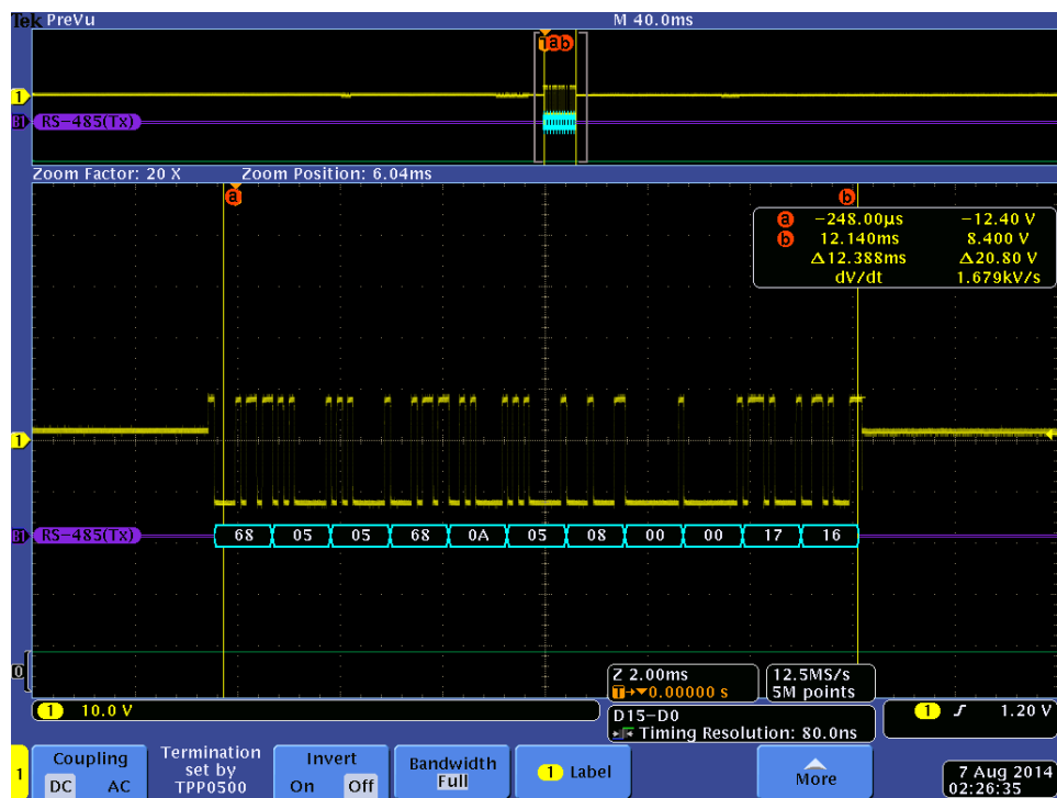
Figura 3.18: Trama enviada del microcontrolador con voltajes modificados por el Gateway.
