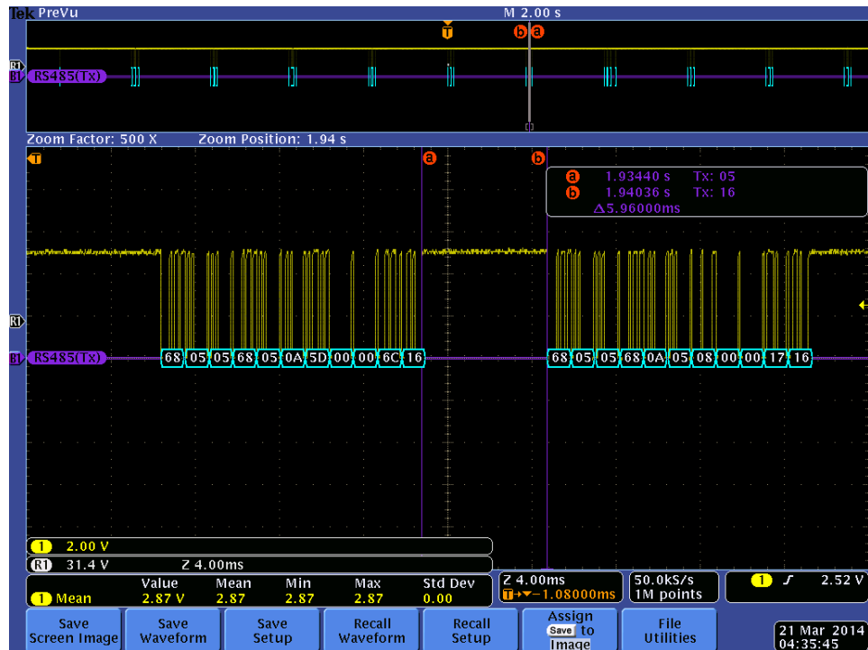
Figura 3.4: Tramas Profibus de verificación luego del proceso de negociación. Fuente: Elaboración propia foto osciloscopio Tektronik MS04034B.
