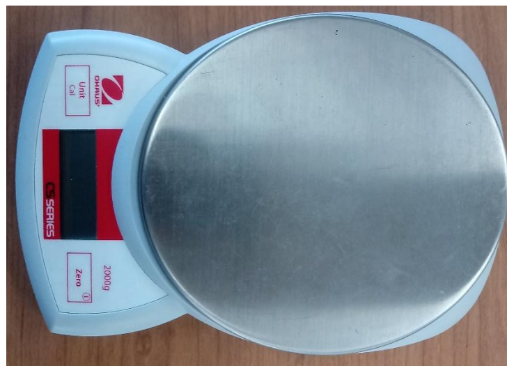
Figura 53. Báscula de laboratorio Ohaus de 2000gr CsSeries
