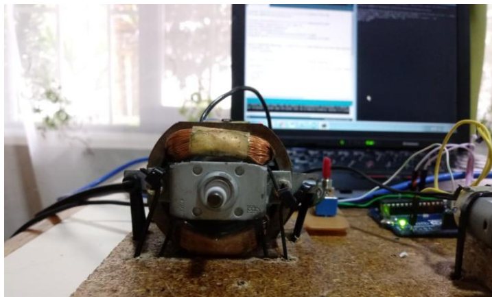
Figura 57. Encoder conectado a motor AC de Secador de Pelo
