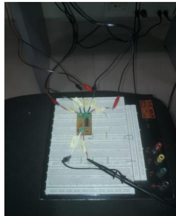
Figura 74. Polarización filtro rechaza bandas.
