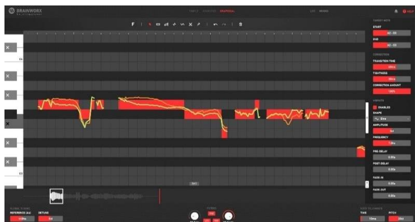
Figura 9. Voz a través de crispytuner, 40ms de fuerza y 100ms de velocidad de transición.
