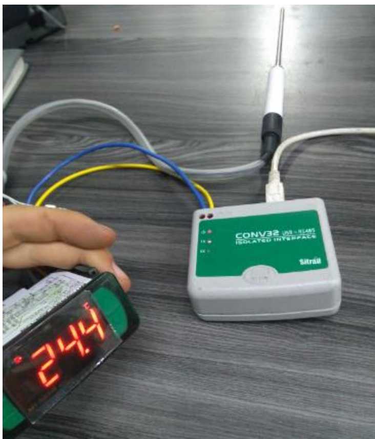
Ilustración 17. Montaje de reconocimiento, Controlador, Pt-100 y conversor RS485-USB
