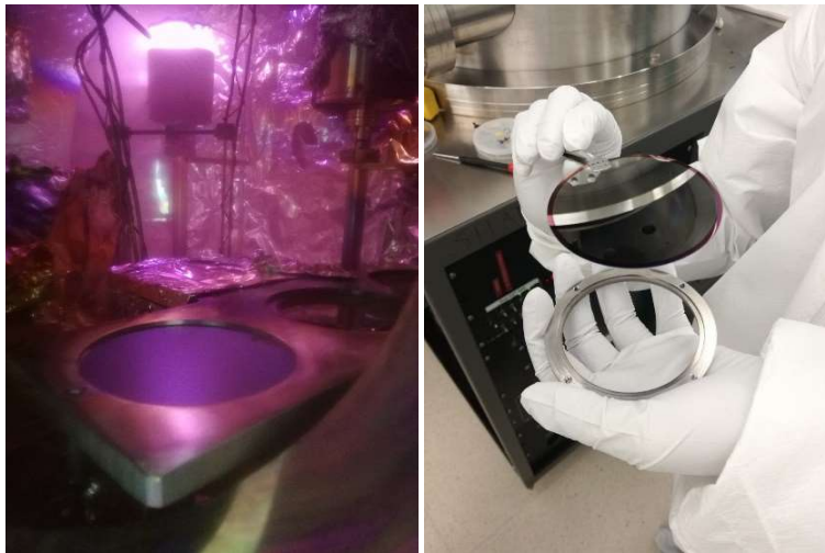
Figura 1.4. Método CSS. A la izquierda, una pistola de plasma realizando pulverización catódica y a la derecha, el resultado.
