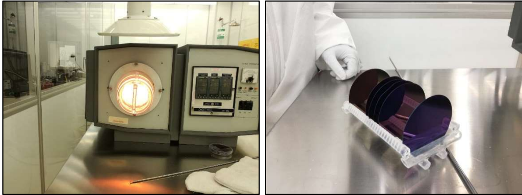
Figura 1.3. Proceso de oxidación. A la izquierda, la maquina donde se lleva a cabo la oxidación. A la derecha, láminas de silicio oxidadas.
