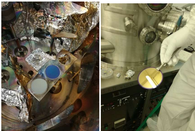
Figura 1.5. Método de evaporación en vacío, cámara de vacío y resultados.
