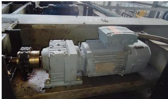
*Figura 23 Motorreductor Navette
