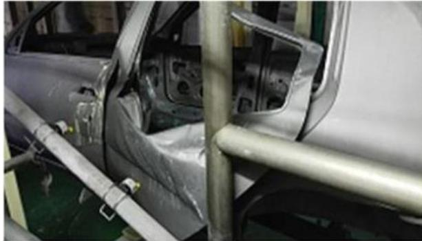
*Figura 3 Destrucción de puertas por desprendimiento de cabinas en Sofasa.
