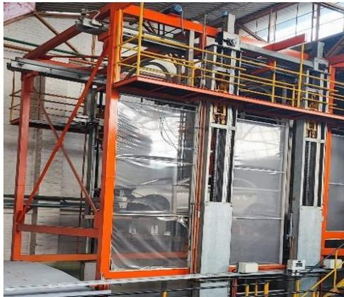
*Figura 32 Columnas guías elevadores TTS
