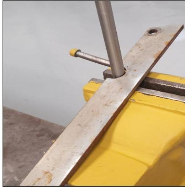
*Figura 42 Palanca de accionamiento de sensor
