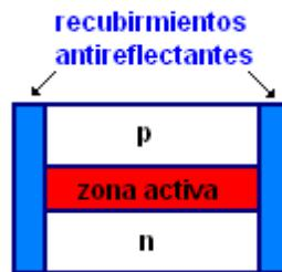
**Figura 4.** Estructura de un SOA de onda viajera
