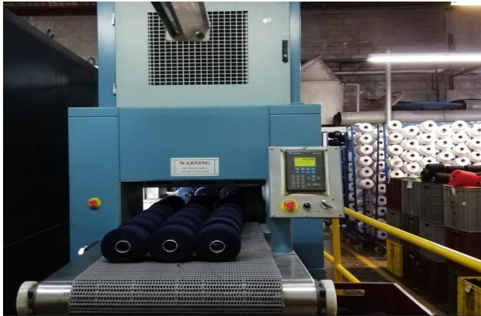
Figura 14. Vista general secador por radiofrecuencia Strayfield. Fuente: autoras
