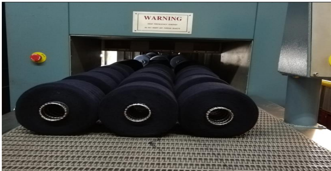
Figura 15. Vista posterior secador por radiofrecuencia Strayfield. Fuente: autoras
