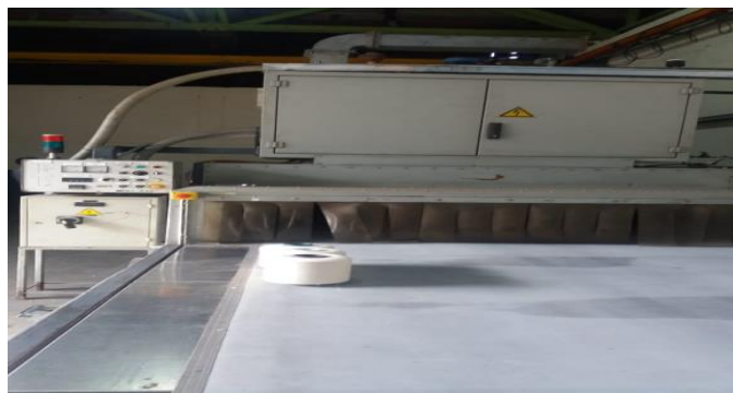
Figura 9. Vista frontal del secador por radiofrecuencia Stalam. Fuente: autoras
