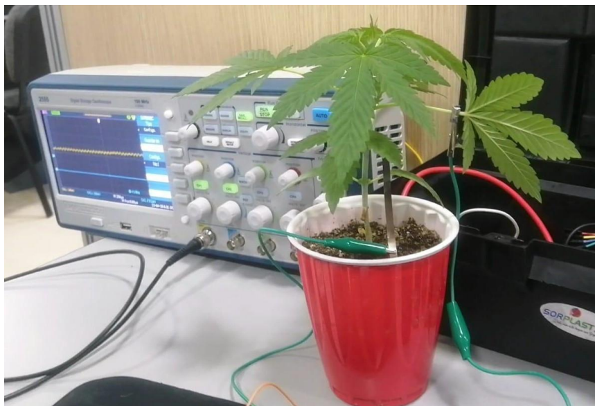
Ilustración 3. Señal de la planta de Cannabis amplificada por el circuito
