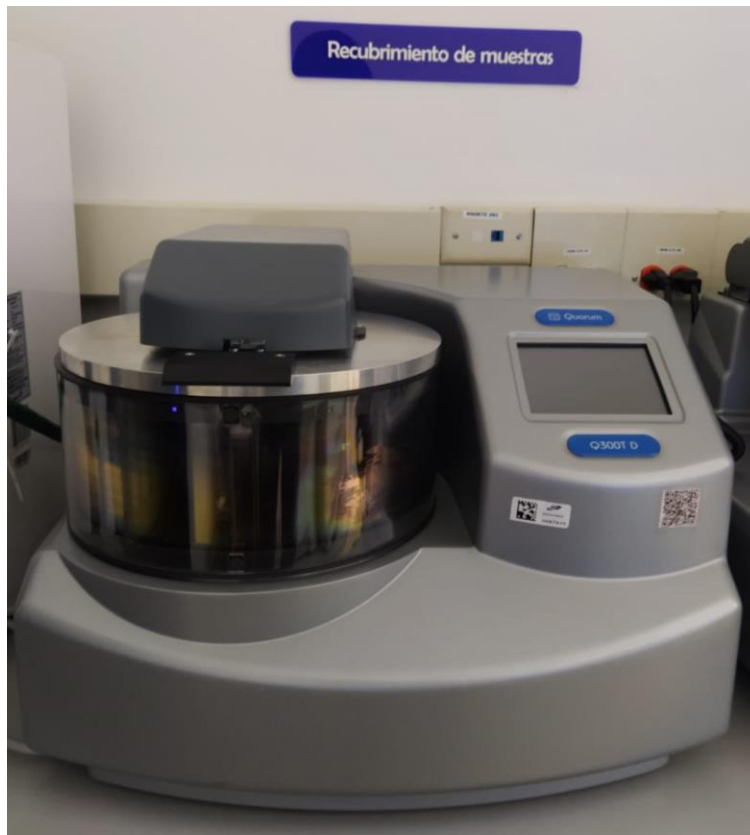
Figura 36. Máquina de pulverización catódica (sputering Q300T D).
