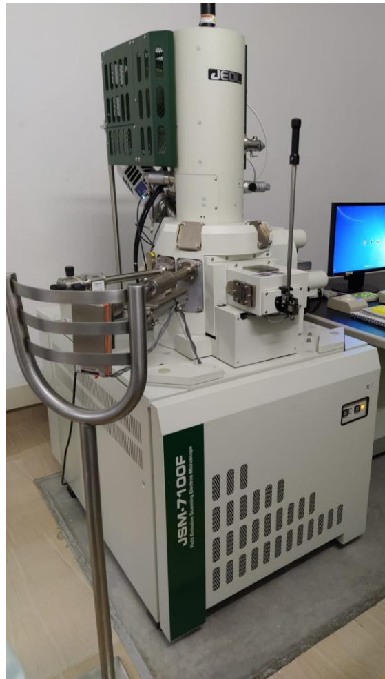
Figura 37. Microscopio electrónico de barrido (SEM).
