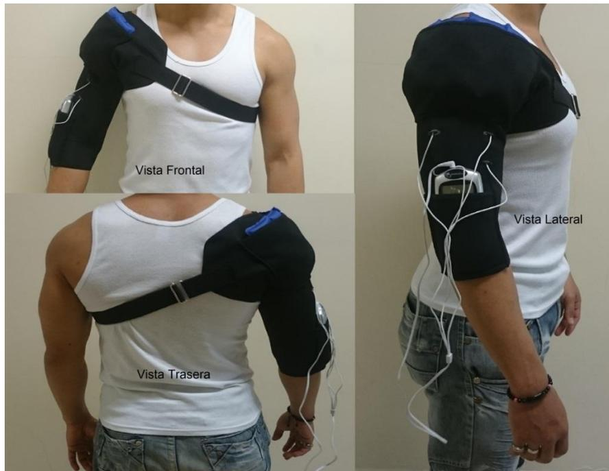
Figura 29- [Vistas del prototipo de la órtesis con sistemas integrados]
