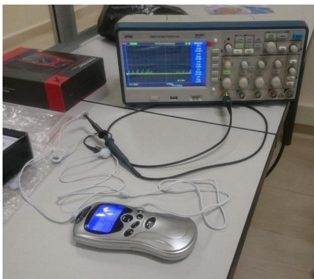
*Figura 19* – [Equipo TENS conectado a Osciloscopio]
