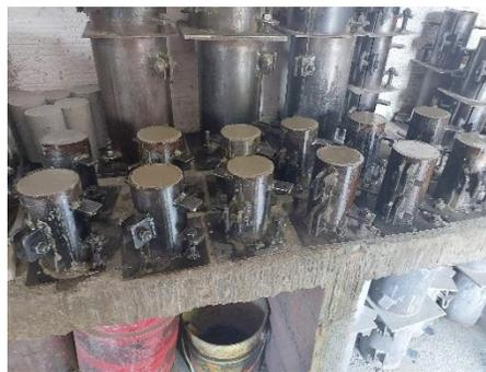
Los cilindros se elaboraron para las edades de fallo 7, 14 y 28 días, se realizaron bajo la norma NTC 4043 de 2021; en esta norma permite el uso de cilindros de tamaños de 76.2 mm y 152.4 mm. Para la fabricación de estos se utilizó una cuchara para colocar la mezcla en 3 capas del mismo volumen, apisonando cada capa 20 veces y dando golpes al lado del molde para retirar las burbujas de aire; además, el lugar donde se tomaron las muestras está
