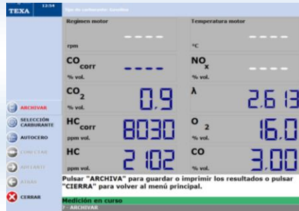
Fig. 1. Medición de gases del motor de gasolina usado en los experimentos.
