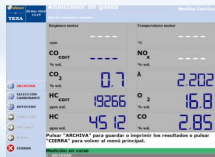
Fig. 2. Medición de gases en el motor aplicando 40 ml de gases HHO por minuto.
