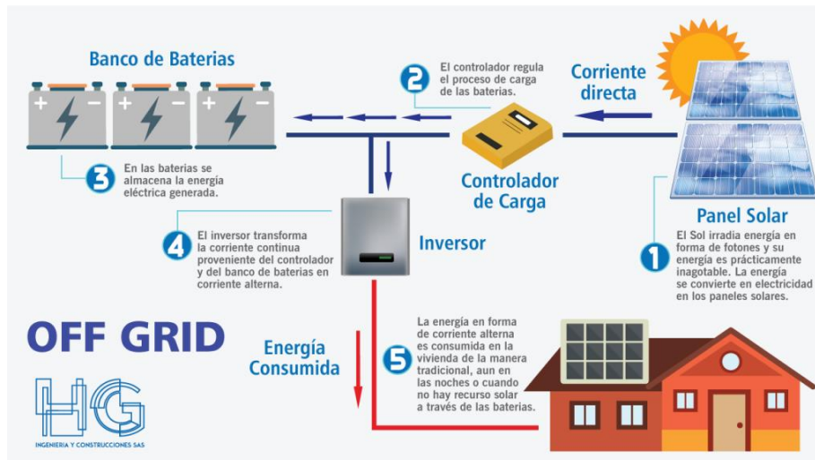
Figura 10. Instalación de sistema solar fotovoltaico aislado Off Grid. Tomado de [14].
