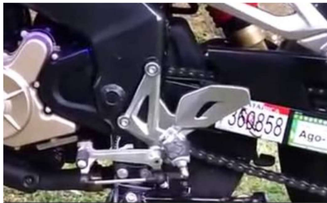
Imagen 7. Soporte de reposa pie (o calapié) izquierdo del piloto. (Auteco Bajaj, 2018).
