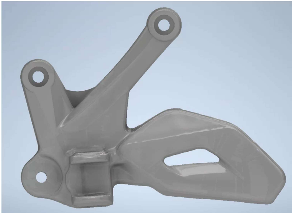
Imagen 17. Diseño optimizado del Soporte reposapié. (Fuente propia, 2023).
