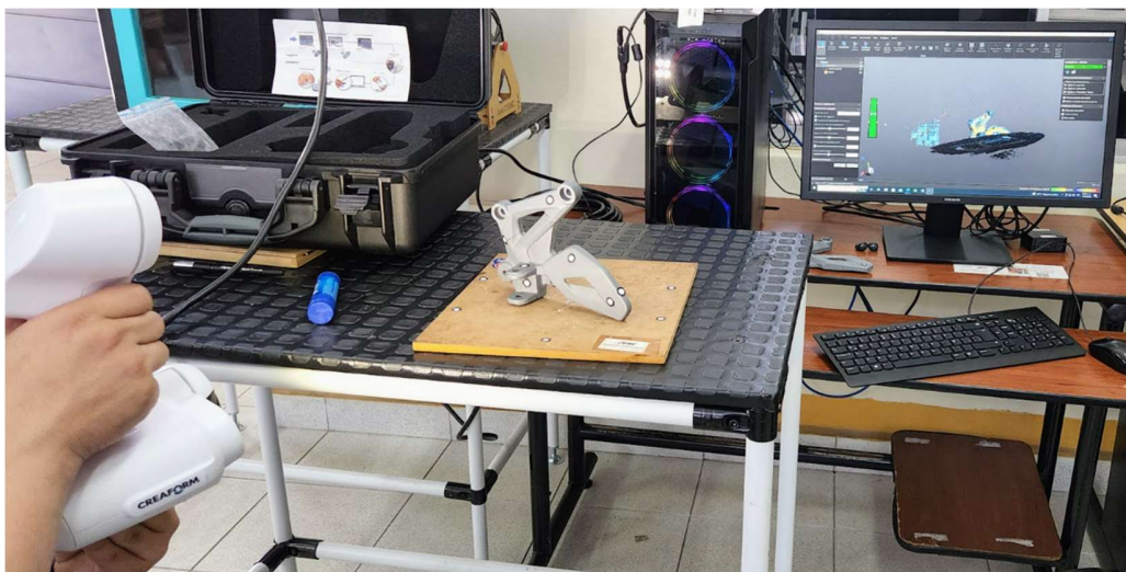
Imagen 12. Procedimiento de escaneado. (Fuente propia, 2023).
