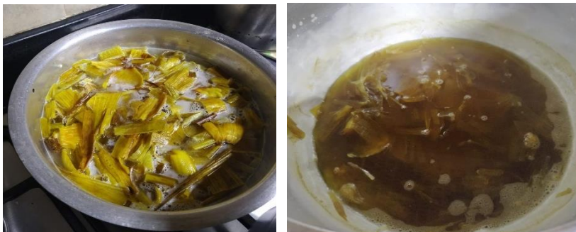
Figura 2-21 Proceso de cocción de la fibra con NaOH; fuente de obtención personal
