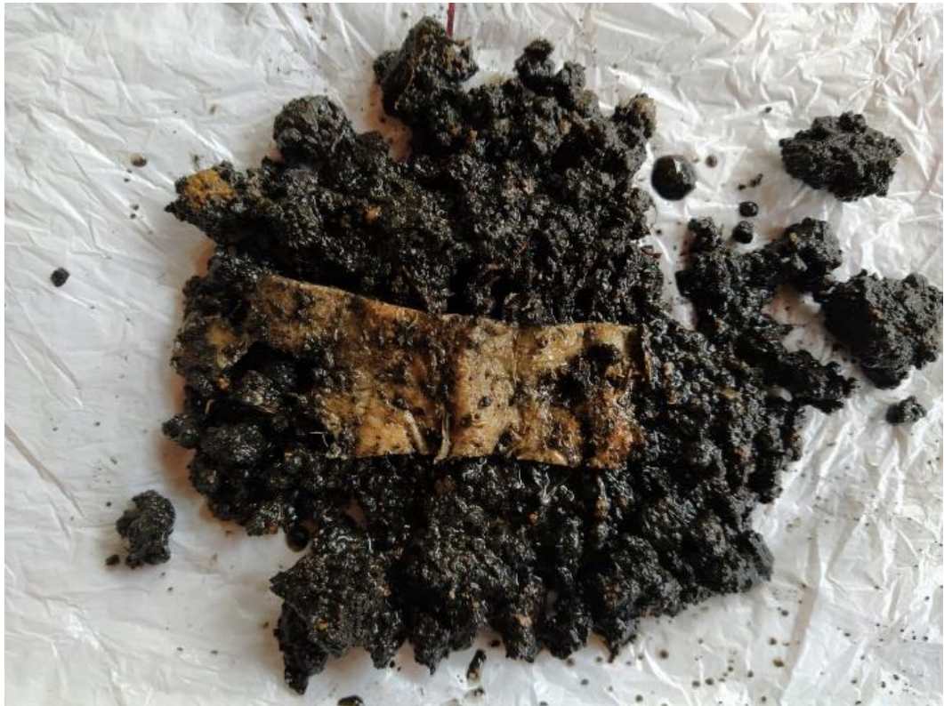
Figura 2-35 Resultado de biodegradabilidad de la probeta rectangular; fuente de obtención personal
