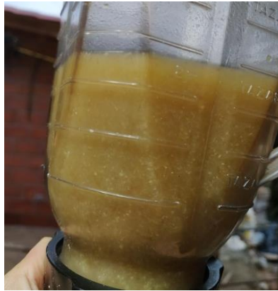
Figura 2-23 Conformado de la pasta de celulosa; fuente de obtención personal
