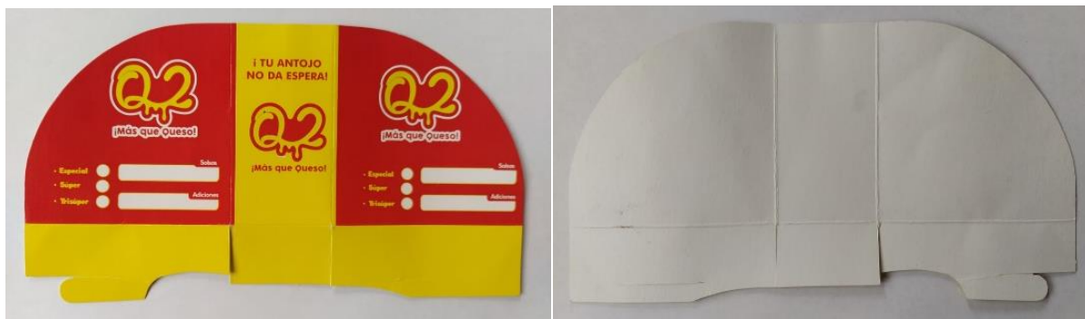
Figura 3-2 Desarrollo del empaque para hamburguesa; fuente de obtención personal
