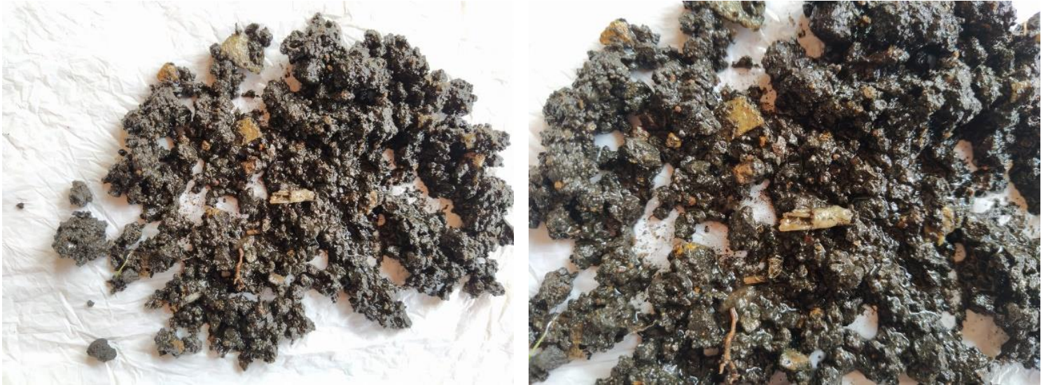
Figura 2-36 Resultados de proceso de biodegradabilidad de la probeta cortada; fuente de obtención personal
