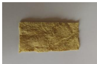
Figura 2-32 Probeta rectangular para el análisis básico de biodegradabilidad; fuente de obtención personal
