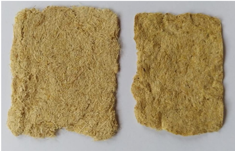
Figura 2-27 Comparación de probetas, a la izquierda probeta B sin NaOH y a la derecha probeta A con NaOH; fuente de obtención personal
