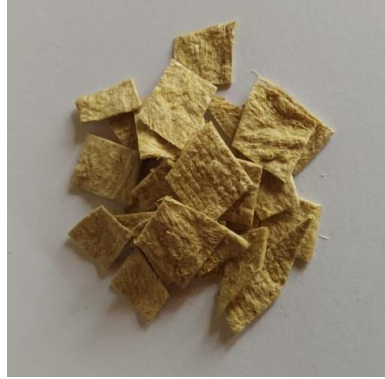
Figura 2-33 Probeta cortada para análisis básico de biodegradabilidad; fuente de obtención personal
