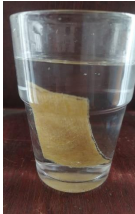
Figura 2-30 Probeta sumergida en agua para comprobar su resistencia a la humedad; fuente de obtención personal
