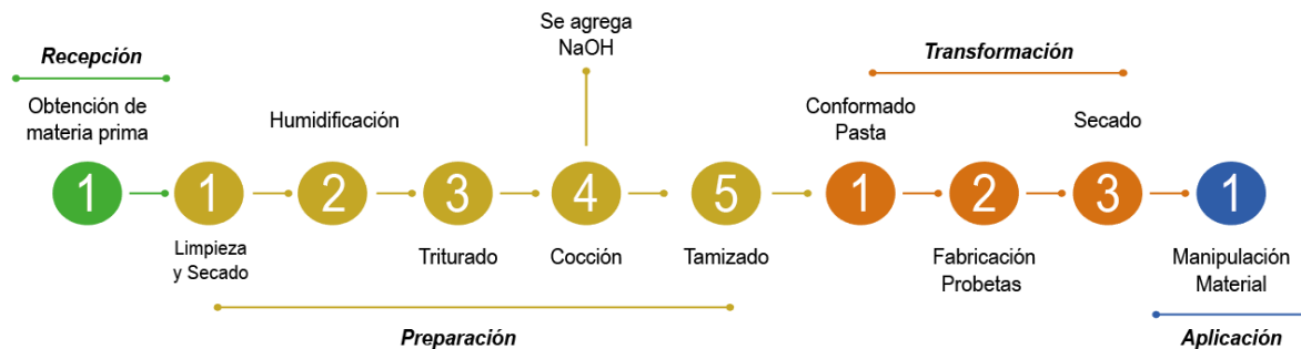
Figura 2-16 Diagrama de Flujo de producción del papel; fuente personal
