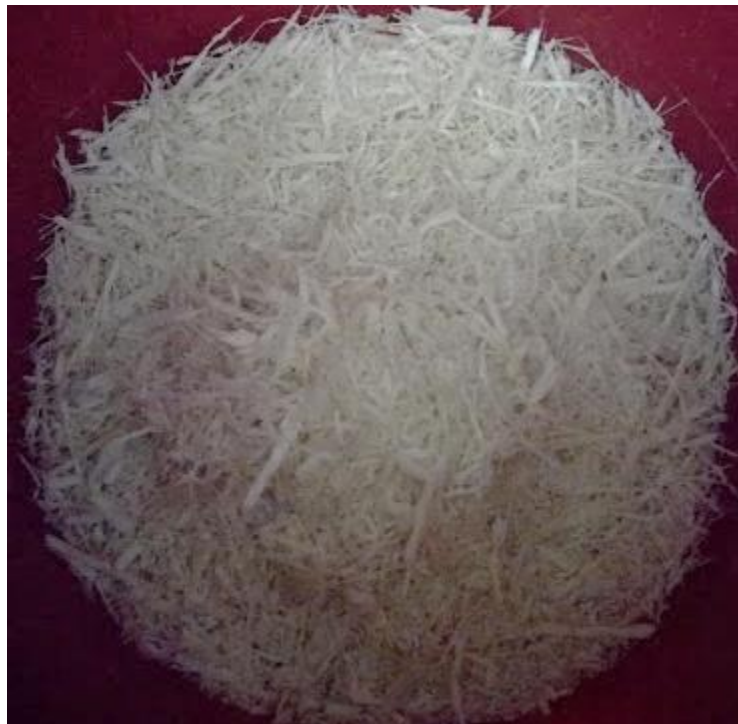
Ilustración 18. Porción de fibra de bagazo de caña triturada.
