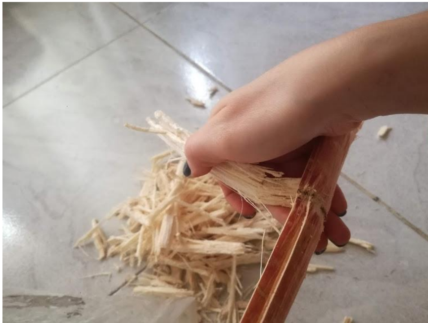
Ilustración 14. Separación de la fibra de la corteza.
