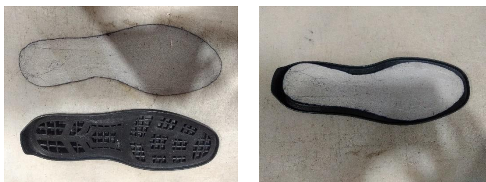
Figura 15. Plantilla de montado y suela
