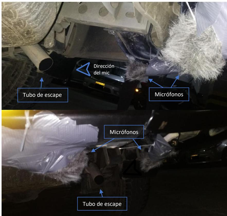
*Nota.* Micrófonos AKG P170 para tubo de escape de camioneta Chevrolet DMAX asegurados en bumper y chasis
