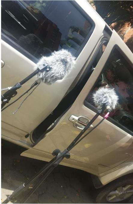
*Nota.* Grabación con un micrófono de condensador (L) y un micrófono dinámico (R) para comparar las diferencias.
