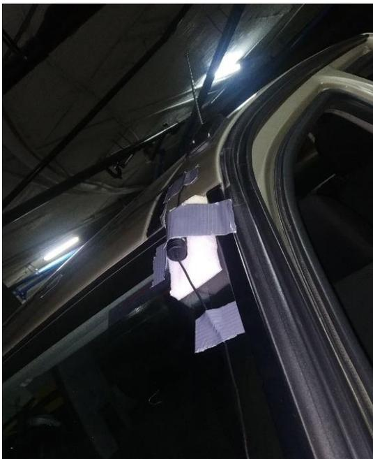
*Nota. Espuma como amortiguador entre la caja del Lavalier y en vidrio frontal*
