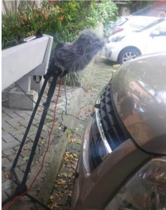
*Nota.* Técnica tipo spot con micrófono AT2020 para motor
