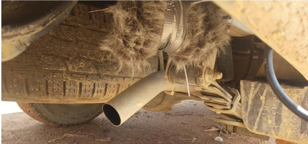
*Nota.* Micrófono AKG D112 para tubo de escape de camioneta Chevrolet DMAX asegurado en el chasis
