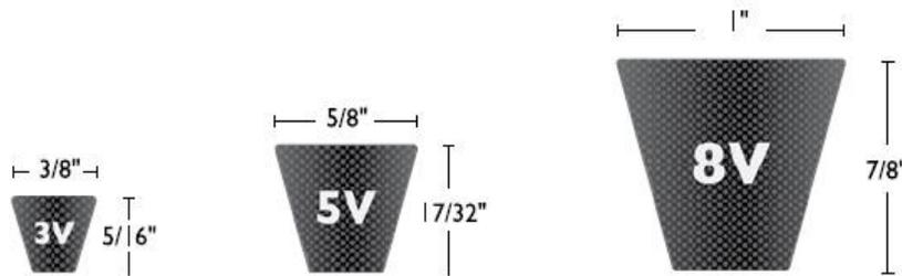
Figura 17. Geometría de la correa en 5V seleccionada.
