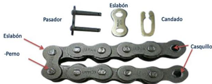
Figura 5. Componentes de una cadena de rodillos.
