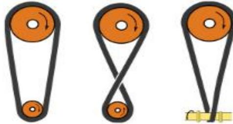
Figura 3. Formas de trabajo de las correas planas, redondas o doble V.
