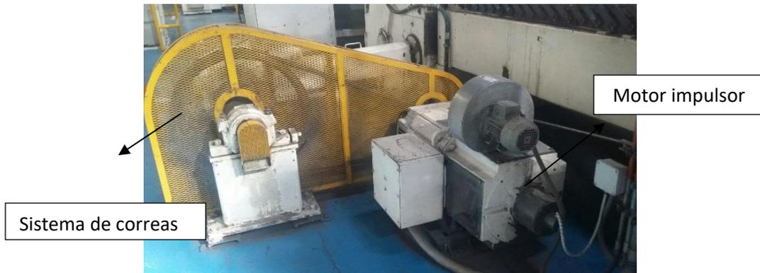
Figura 9. Sistema de transmisión de potencia del módulo 1 de la máquina corrugado.
