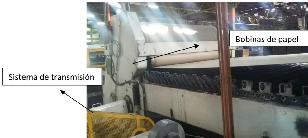
Figura 8. Módulo 1 de la máquina productora de cartón corrugado.
