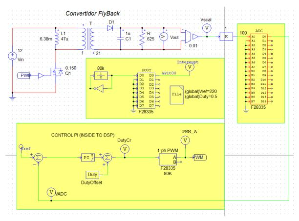
Figura. 76. Diagrama de control PI con elementos de hardware para programación en DSP F28335.
