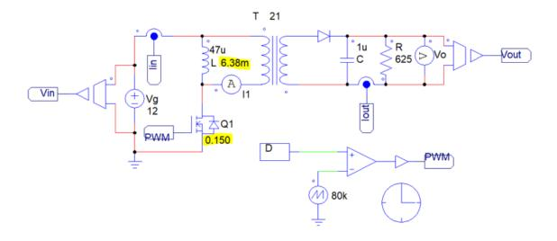
Figura 10. Simulación convertidor FlyBack con pérdidas.
