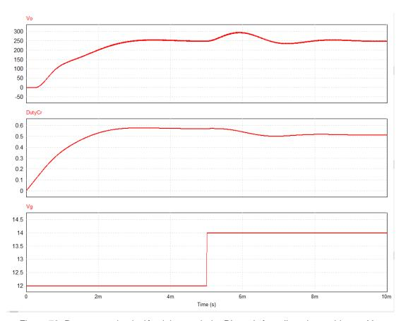
Figura 72. Respuesta simulación del controlador PI continúo aplicando cambios en Vg.
