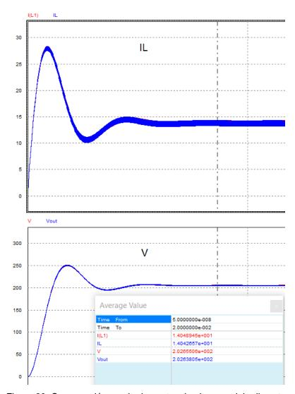
Figura 20. Comparación resultados entre circuito y modelo discreto.
