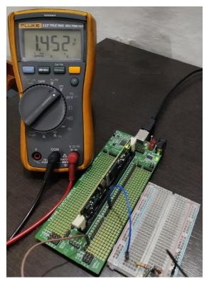
Figura 60. Salida de voltaje con duty=0.4, PWM interno
