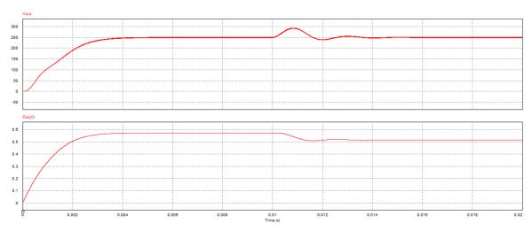
Figura 75. Respuesta simulación del controlador PI discreto aplicando cambios en Vg
