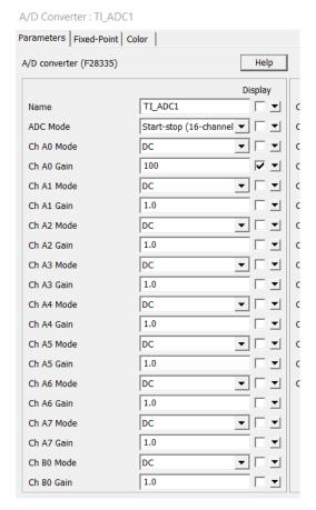
Figura. 77. Configuración modulo ADC para el controlador PI.
