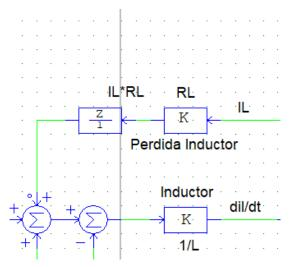
Figura 28. Aplicación de retardo unit delay.
