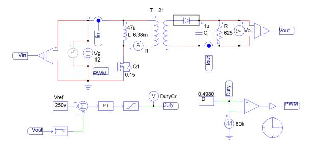
Figura 71. Convertidor FlyBack con controlador PI continuo en PSIM.
