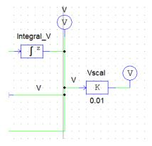
Figura 22. Escalización de señal de control en PSIM.
