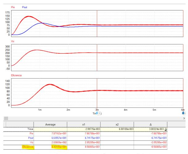
Figura 11. Resultados de la simulación del convertidor FlyBack.
