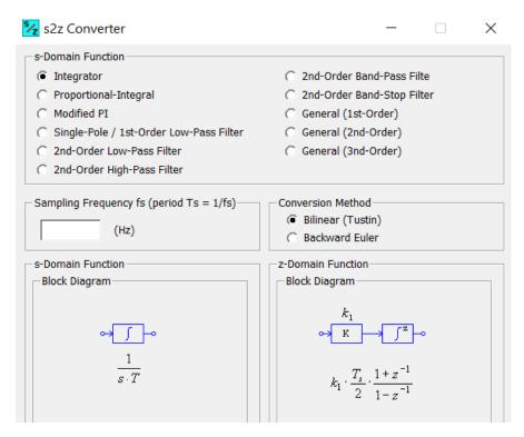
Figura 6. Convertidor control analógico a digital, s2z Converter
