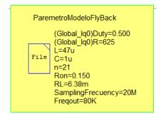
Figura 19. Parámetros del modelo discretizado en parameter file.
