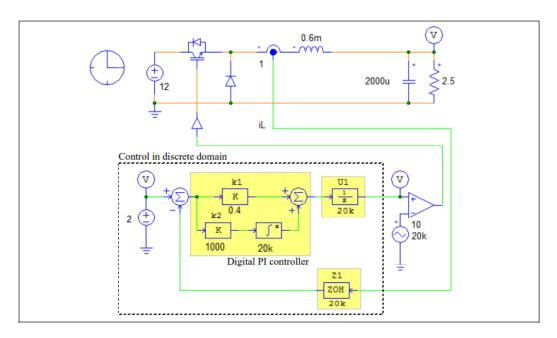
Figura 7. Sistema de convertidor CC en modo de control discreto.
