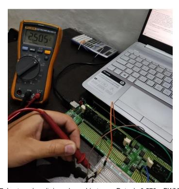
Figura 67. Lectura de voltaje en lazo abierto con Duty de 0.570 y PWM externo.
