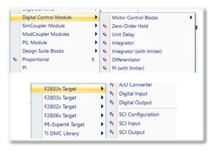
Figura 4. Elementos compatibles con generación de código.
