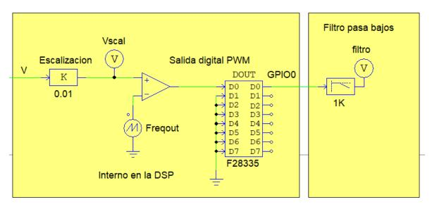
Figura 23. Salida de voltaje PWM y Filtro pasa bajos en PSIM
