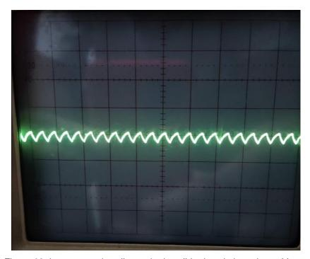
Figura 68. Lectura en el osciloscopio de salida de voltaje en lazo abierto.
