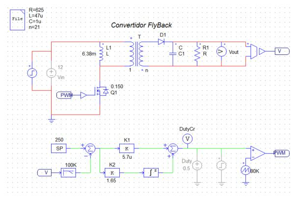
Figura 74. Convertidor FlyBack con controlador PI discreto.
