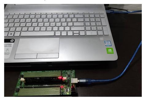
Figura 46. Conexión de la DSP al computador.
