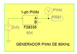
Figura 63. Generador PWM en PSIM SimCoder.
