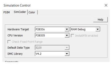
Figura 31. configuración de hardware de destino.
