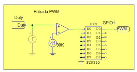
Figura 62. Configuración entrada PWM.
