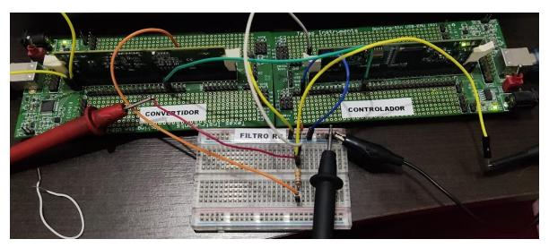
Figura. 80. Montaje físico plataforma HIL.
