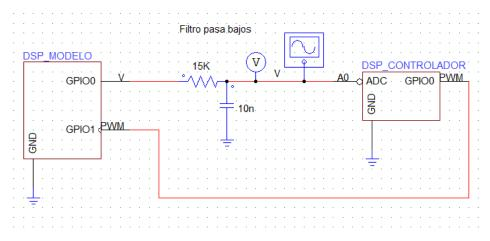
Figura. 79. Diagrama de conexión en lazo cerrado.
