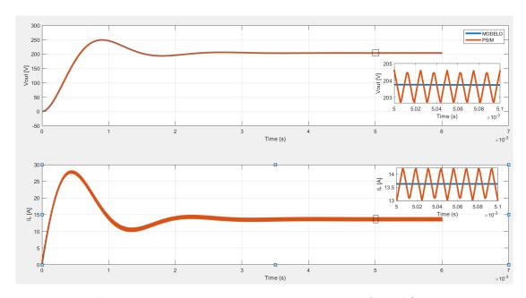
Figura 12. Modelo no lineal promediado vs simulación en PSIM.
