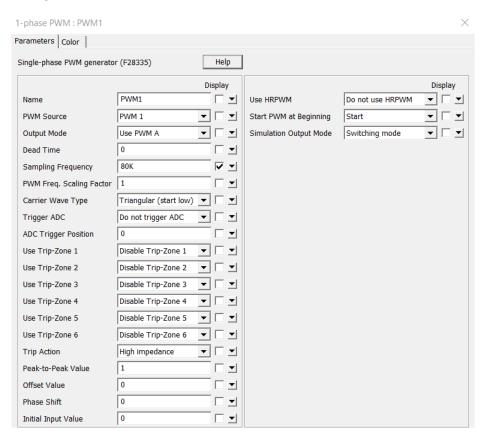
Figura 64. Configuración generadora PWM de una fase.
