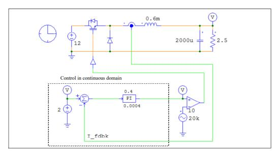
Figura 5. Sistema de convertidor CC en modo de control continuo.
