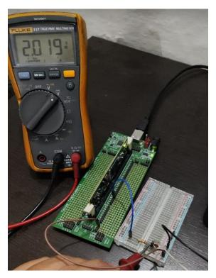
Figura 59. Salida de voltaje con duty=0.5, PWM interno.
