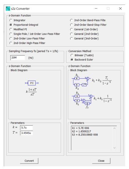
Figura 73. Configuración del convertidor de controlador PI continuo a discreto.
