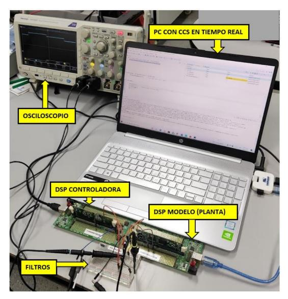
Figura 82. Implementación final de la plataforma HIL.
