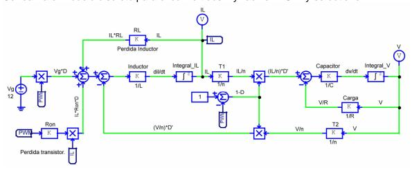
Figura 13. Modelo discreto convertidor Flyback con pérdidas en inductor y transistor.
