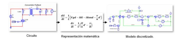
Figura 21. Modelado discreto de un convertidor.
