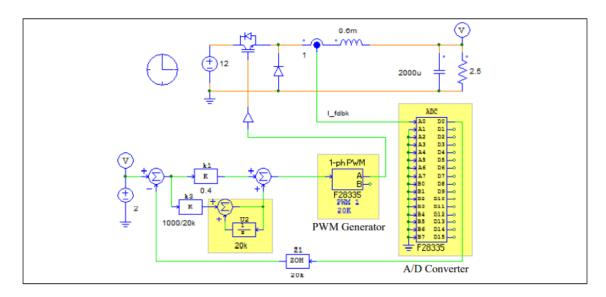
Figura 8. Convertidor CC con elementos de hardware F2833X.
