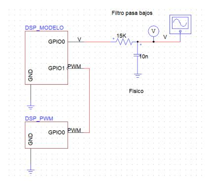
Figura 66. Diagrama de conexión en lazo abierto.
