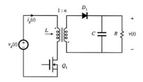
Figura 9. Convertidor elevador FlyBack.
