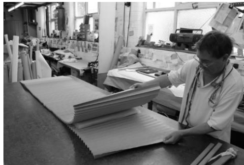
Figura 13: Dejar enfriar y retirar (Ciment pleating, 2021)
