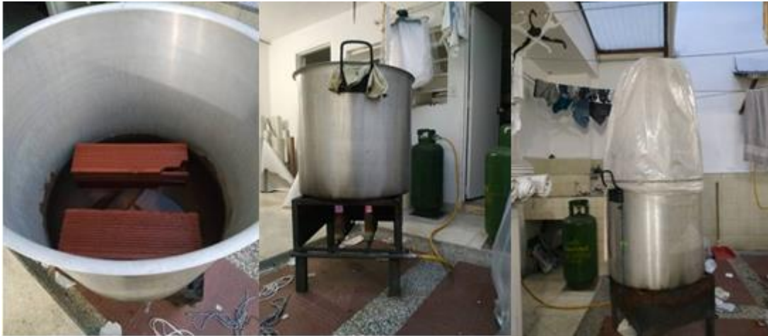
Figura 1: Máquina artesanal de Plisados Cristal. Izquierda: base de la máquina. Centro Aspecto general. Derecha: Plástico utilizado. Fuente: autores
