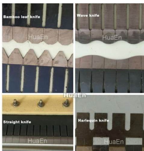
Figura 21: Moldes para plisado (HuaEn Machinery, 2021)
