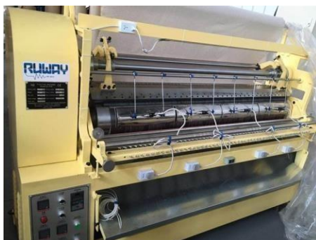
Figura 14: Máquina plisadora para vestidos ZJ-416 (HuaEn Machinery, 2021)
