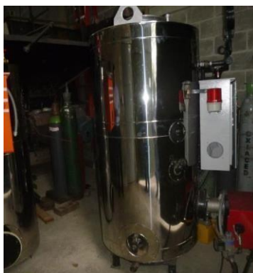
Figura 27: Caldera 2 BHP Piro-tubular de posición vertical (Calderas & Quemadores S.A.S, 2020)
