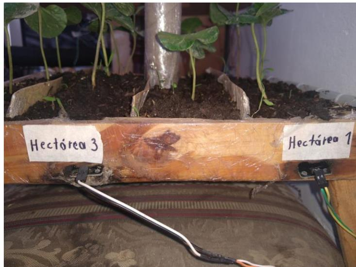
Figura 7. Adaptación de sensores de humedad YL-38, número 1 y 3. Fuente: foto tomada por los autores
