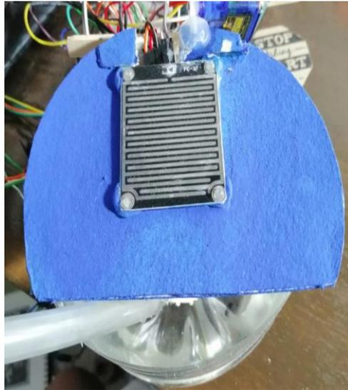
Figura 10. Adaptación de sensor de lluvia FC-37. Fuente: foto tomada por los autores
