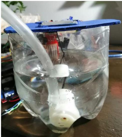
Figura 11. Adaptación de sensor de nivel de agua para Arduino. Fuente: foto tomada por los autores
