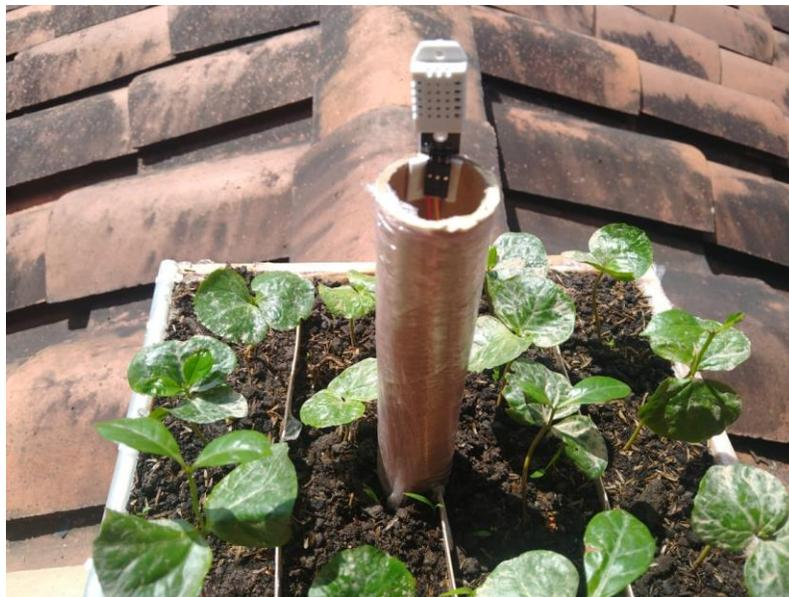
Figura 9. Adaptación de sensor de temperatura DHT22. Fuente: foto tomada por los autores
