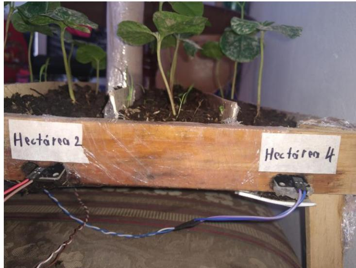
Figura 8. Adaptación de sensores de humedad YL-38, número 2 y 4. Fuente: foto tomada por los autores
