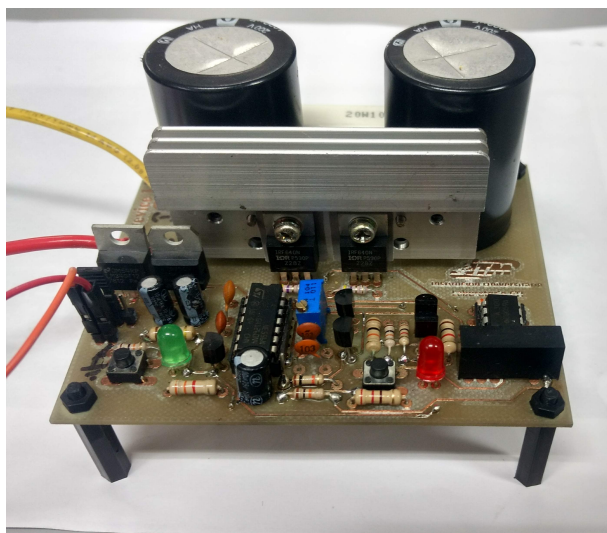
(a) Montaje físico Sweep Device
