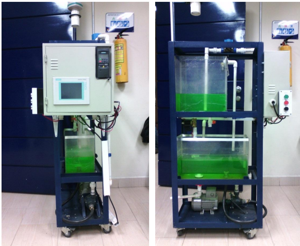
Fig. 5. Planta de control de nivel de líquidos.
