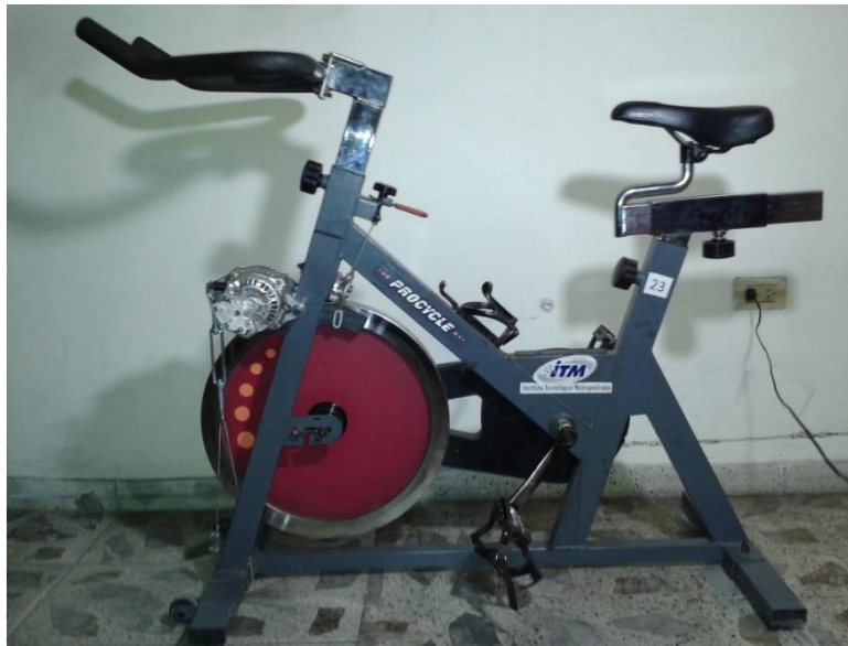
Figura 26. Ensamble alternador a bicicleta.
