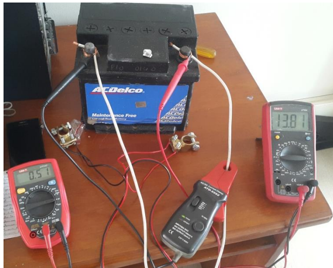
Figura 37. Toma de datos para carga de batería.
