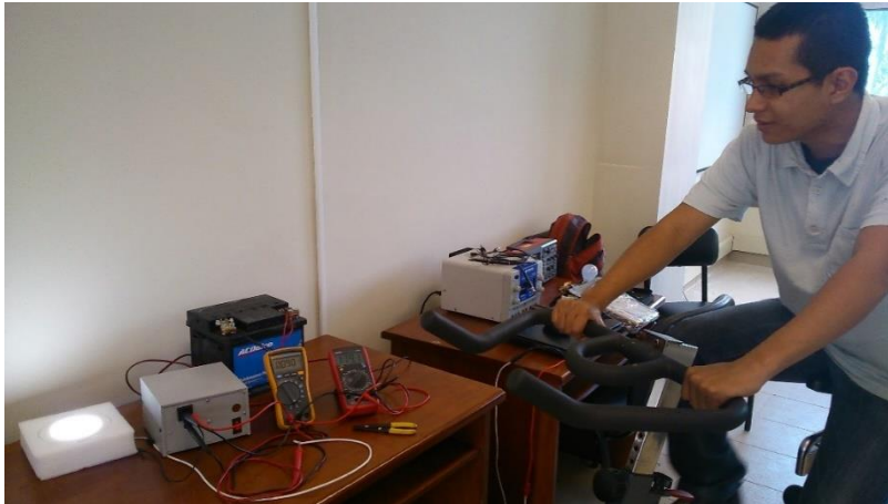
Figura 41. Prueba con carga LED 10W.
