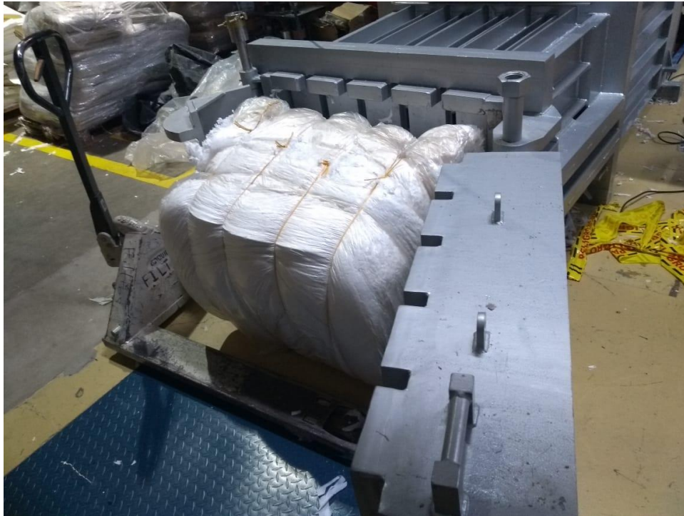
Figura 43. Paca de polietileno realizada en modo manual. La paca tiene una mediada aproximada de 95 x 80, medidas aproximadas de equivalentes a una sola bolsa de este material sin compactar.
