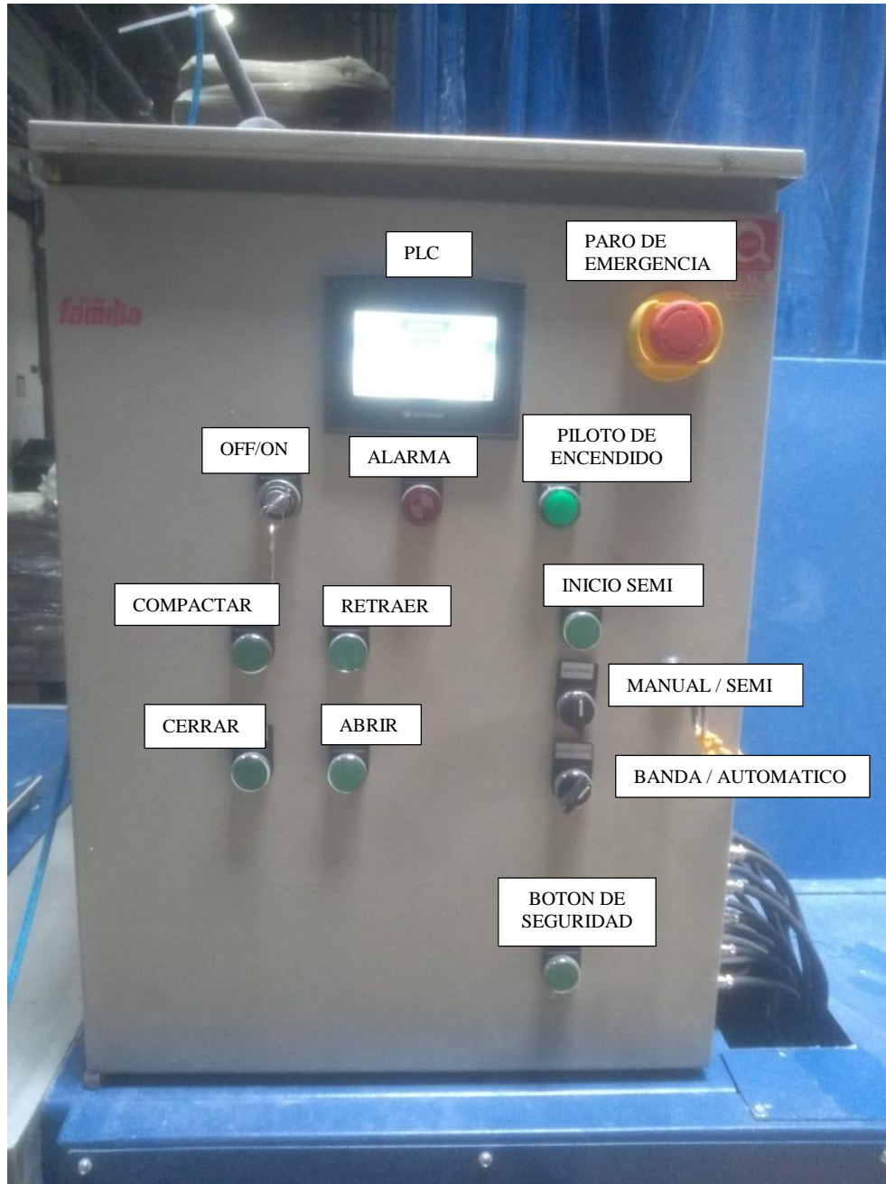
Figura 41. Botones del tablero de control. El piloto de se encenderá siempre que el motor de la bomba se encienda. El botón de seguridad garantiza que el operario mantenga ocupado las dos manos para operar la máquina en modo manual.
