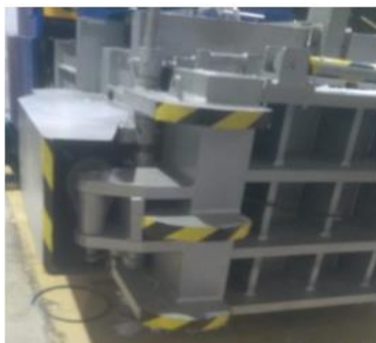
Figura 3. Sistema de cierre tipo tenaza. En la fotografía se observa la tenaza cerrando y asegurando completamente la puerta, evitando que se abra con la fuerza aplicada por el cilindro de compactación.
