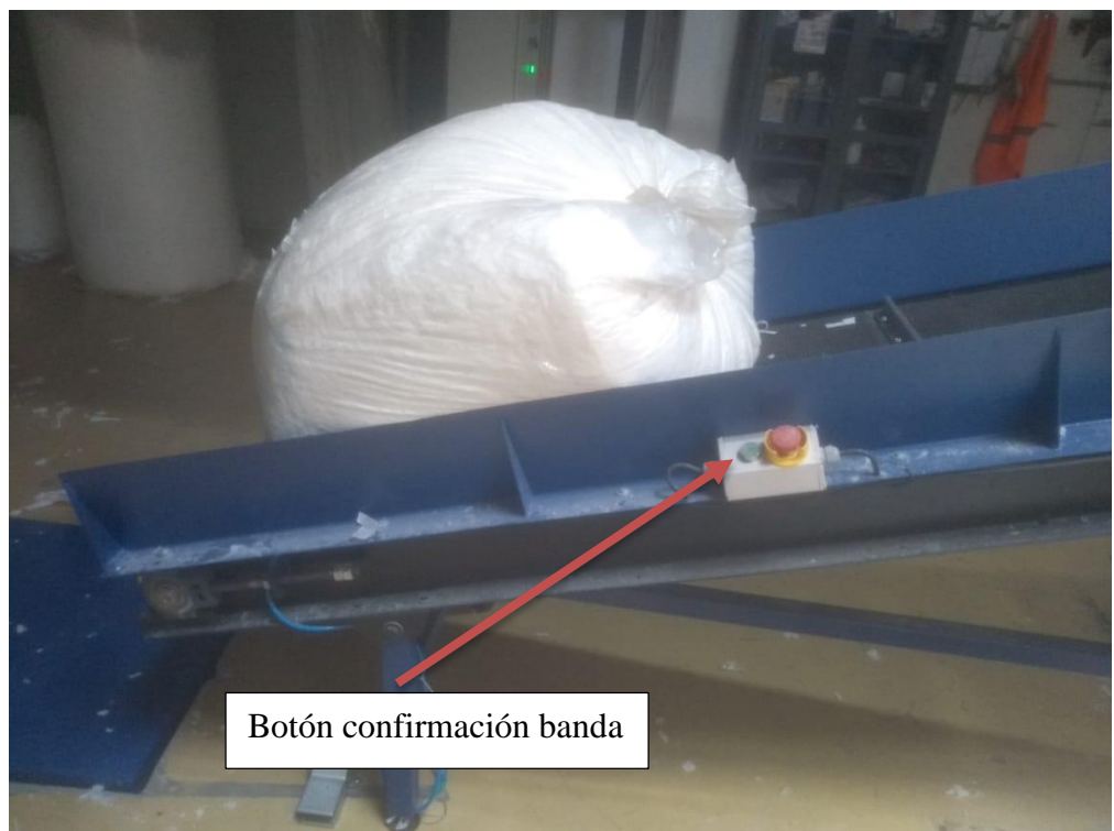
Figura 6. Pulsador para encender la banda. Una vez posicionado el material en la banda se pulsa el botón de “confirmación banda” para encenderla.
