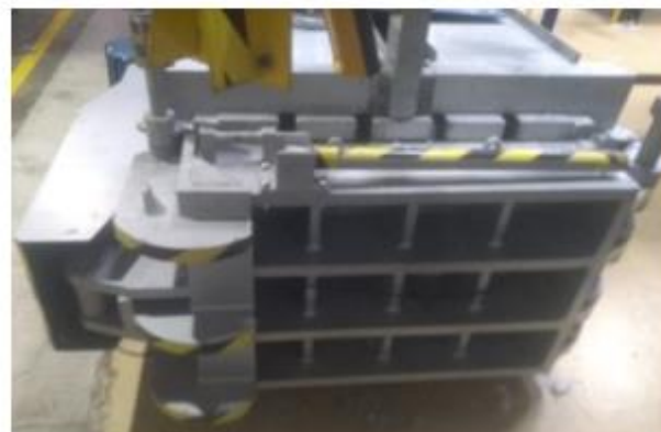
Figura 3. Sistema de cierre tipo tenaza. En la fotografía se observa la tenaza cerrando y asegurando completamente la puerta, evitando que se abra con la fuerza aplicada por el cilindro de compactación.
