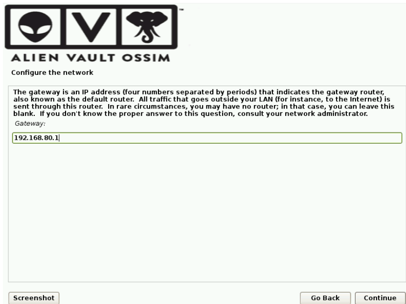
Ilustración. Instalación OSSIM - Configuración Gateway (Elaboración propia).
