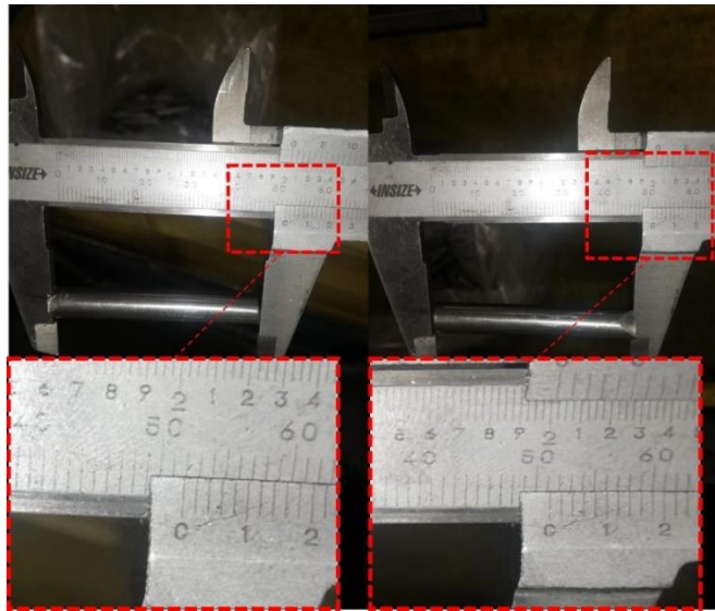
Figura 23. Medida de corte en troqueladora. (Autoría Propia)
