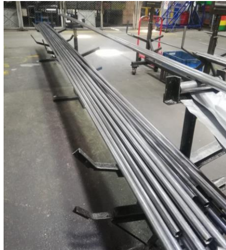
Figura 17. Soportes tubería sierra circular. (Autoría propia)
