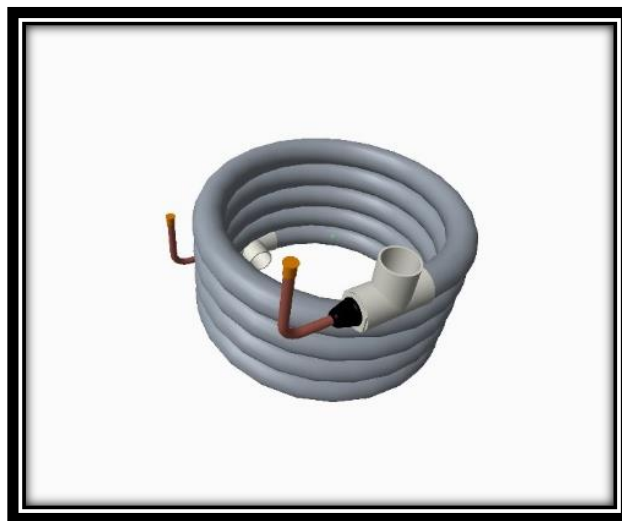
Figura 33 Intercambiador de calor
