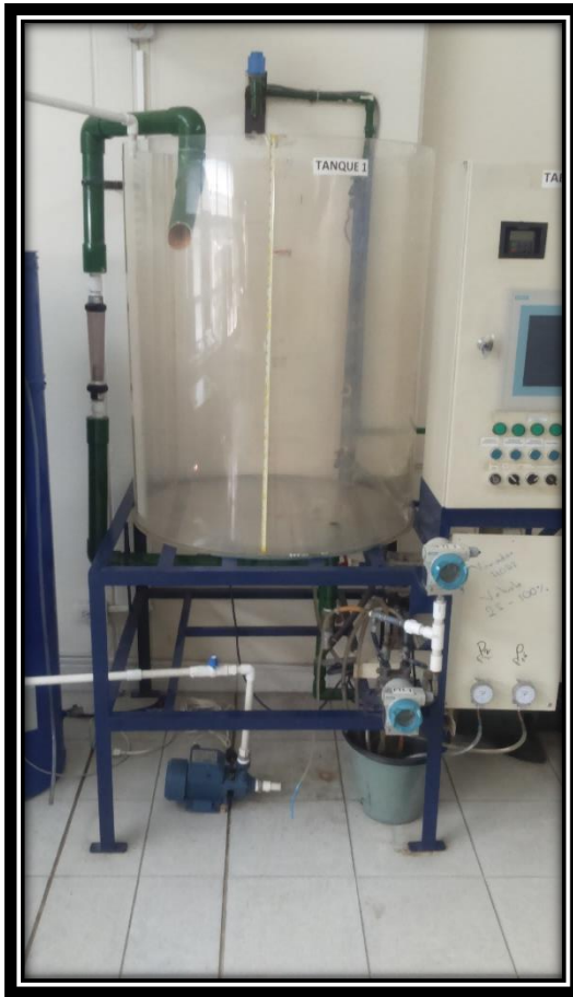
Figura 17 Tanque 1, estructura soporte y Fluxómetro.
