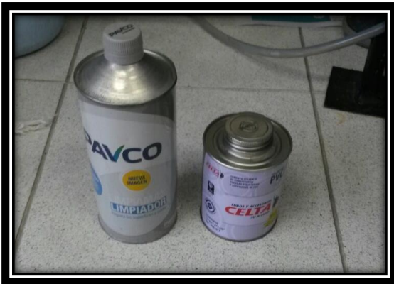
Figura 50 Soldadura y acondicionador pvc
