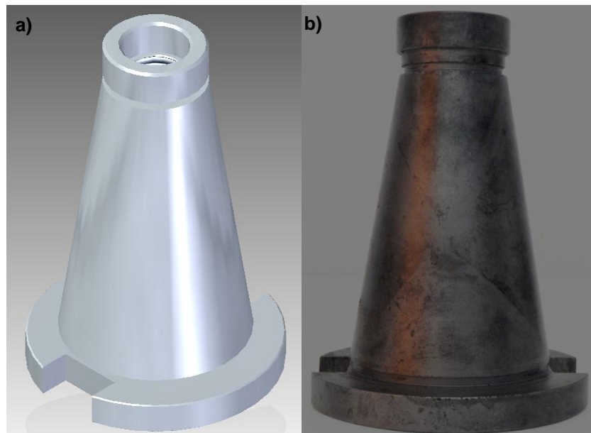
Figura 16. Cono morse: a) Modelo diseñado mediante Solid Edge® ST5 y b) fotografía del cono fabricado. Fuente propia.
