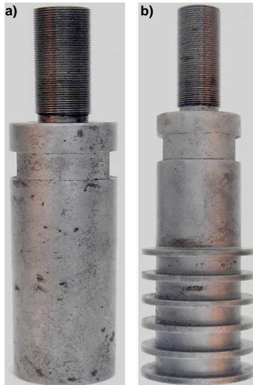
Figura 12. Fotografías de los vástagos fabricados: a) liso y b) con aletas desplazadas. Fuente propia.
