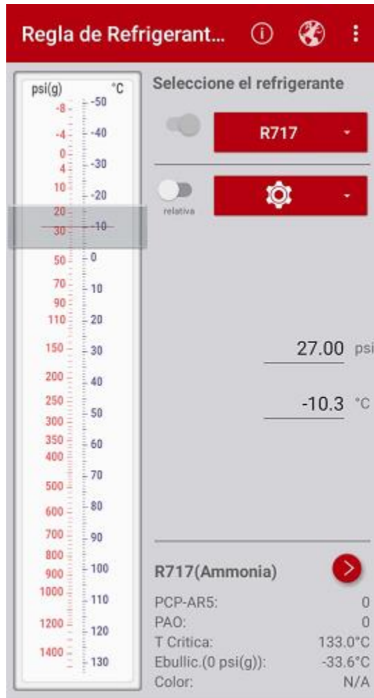
Figura 18. Temperatura del amoniaco a 27 psi (Danfoss, 2019)
