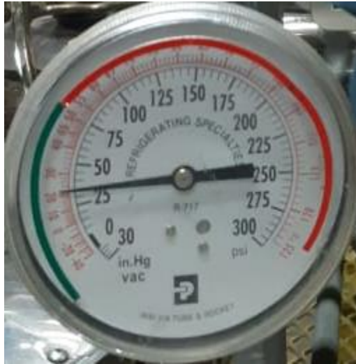
Figura 25. Manovacuómetro Parker 30 in.Hg – 300 psi (Fuente propia)
