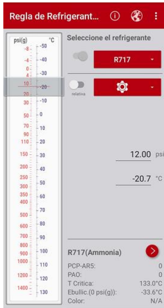
Figura 28. Temperatura de evaporación para 12 psi con amoníaco (Danfoss, 2019)
