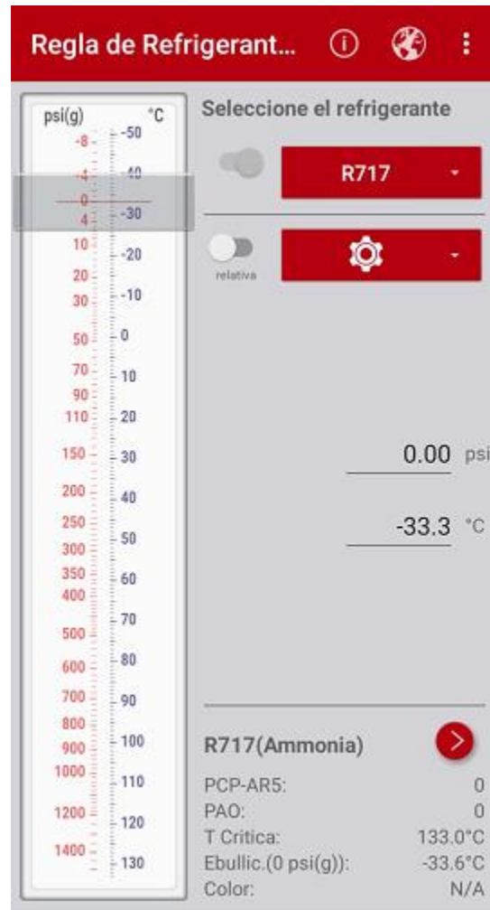
Figura 19. Temperatura del amoniaco a 0 psi (Danfoss, 2019)
