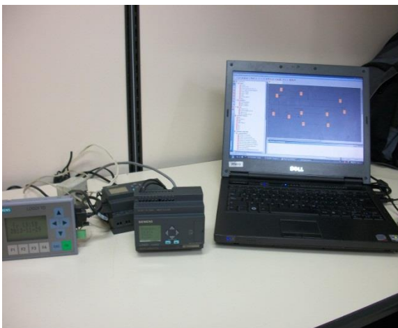
Figura N.4.4.3. 3. Programación del PLC.
