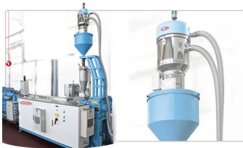
Figura 19. Propuesta Extrusora de perfilaría con tolva de autoabastecimiento. http://www.andexport.com/espanol/prod_extrustub_mag_monohusillo.php# .
