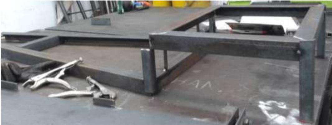
**Figura 3. Construcción de la estructura del chasis.**
