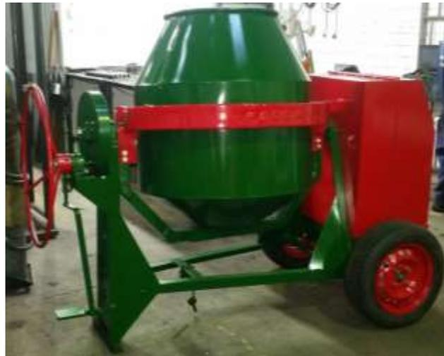
**Figura 8. Rediseño final de la mezcladora 12 ft<sup>3</sup>.**
