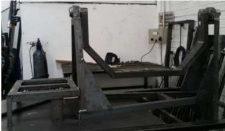
**Figura 7. Ensamble de toda la estructura de la mezcladora.**
