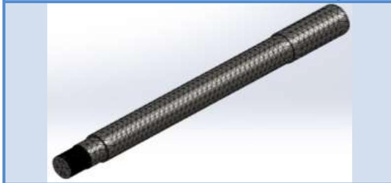
En la tabla 22 se especifican los esfuerzos que sufre la pieza debido a las cargas aplicadas, calculadas previamente, y se muestra en qué punto se concentra el más alto, que en este caso es de 338.82 MPa, el cual se encuentra por debajo del límite elástico del material, 460 MPa, lo que indica que el eje del tambor no debe fallar, garantizando así que este tendrá un correcto funcionamiento y le dará un buen soporte al tambor y a la mezcla,
