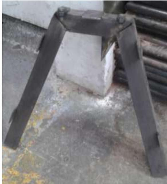
**Figura 4. Espaldar del chasis para el apoyo del cajón.**
