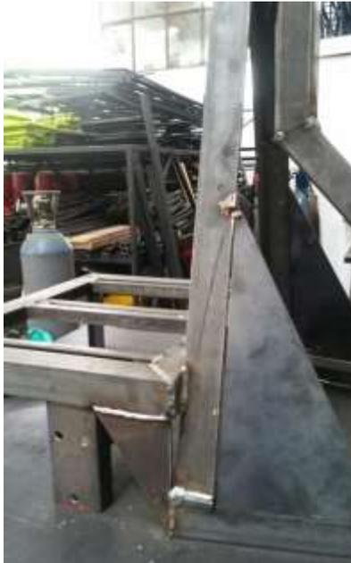
**Figura 5. Refuerzos en el chasis para generar mayor resistencia en la estructura.**
