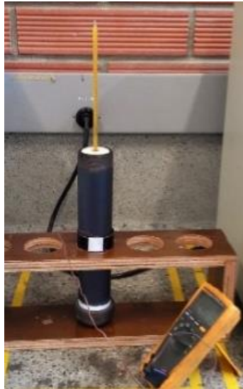
Fig. 2 Montaje realizado para las pruebas de transferencia de calor en estado transitorio. Fuente: autores.
