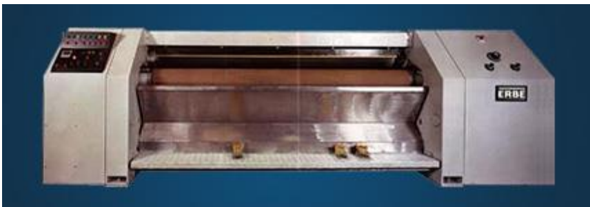
Figura 4. Fuente máquina hidráulica de escurrir, estirar y satinar
