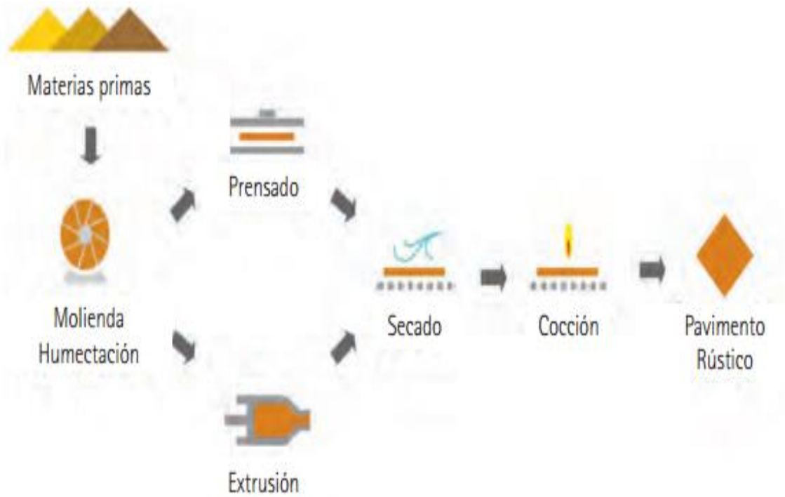
Ilustración 18 Esquema del proceso de fabricación de gres rustico (Fuente: Monfort, 2011)
