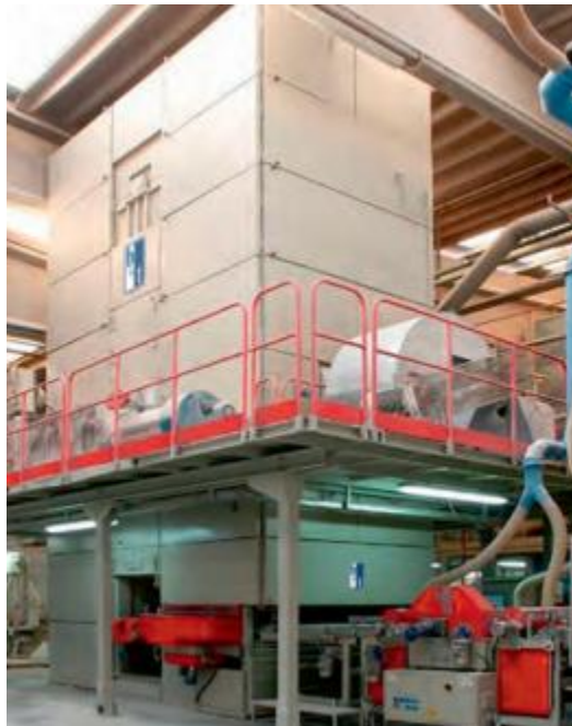
Ilustración 13 Secadero vertical para el secado de baldosas cerámicas (Fuente: Monfort, 2011)
