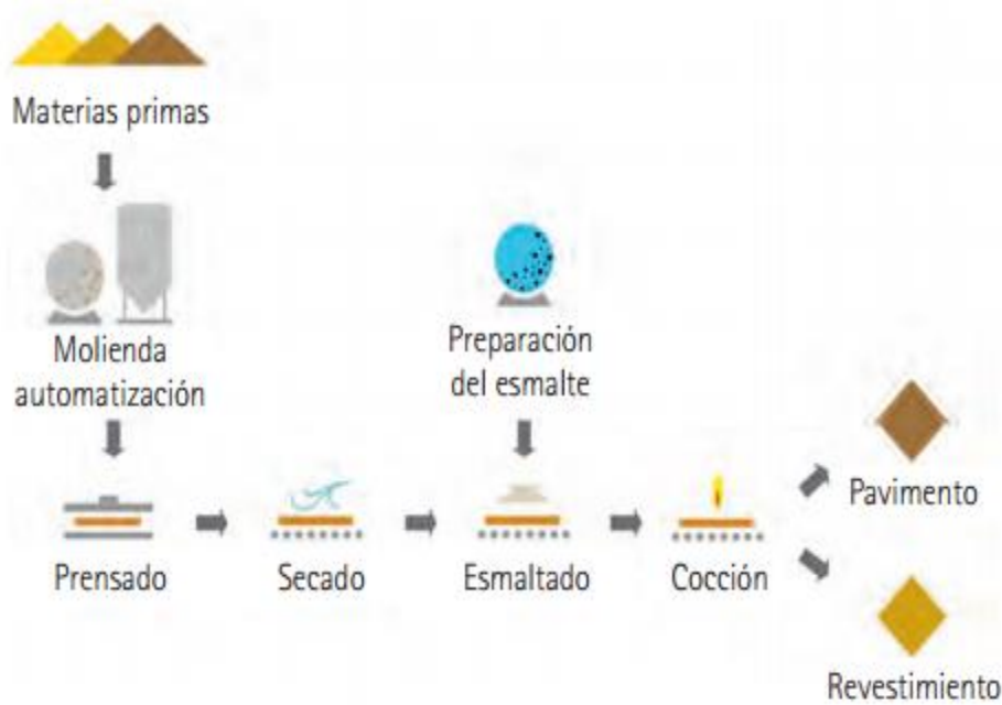
Ilustración 15 Esquema del proceso de fabricación de baldosas cerámicas por monococción (Fuente: Monfort, 2011)
