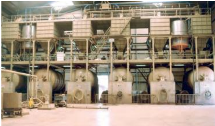
Ilustración 9 Molinos de bolas para la molienda de materias primas (fuente: Monfort, 2011)
