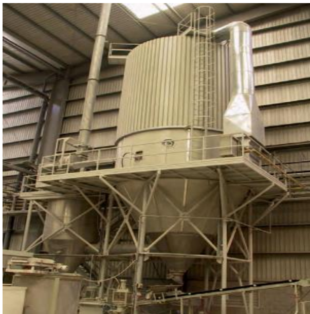
Ilustración 10 Atomizador empleado en el secado de la barbotina (Fuente: Monfort, 2011)
