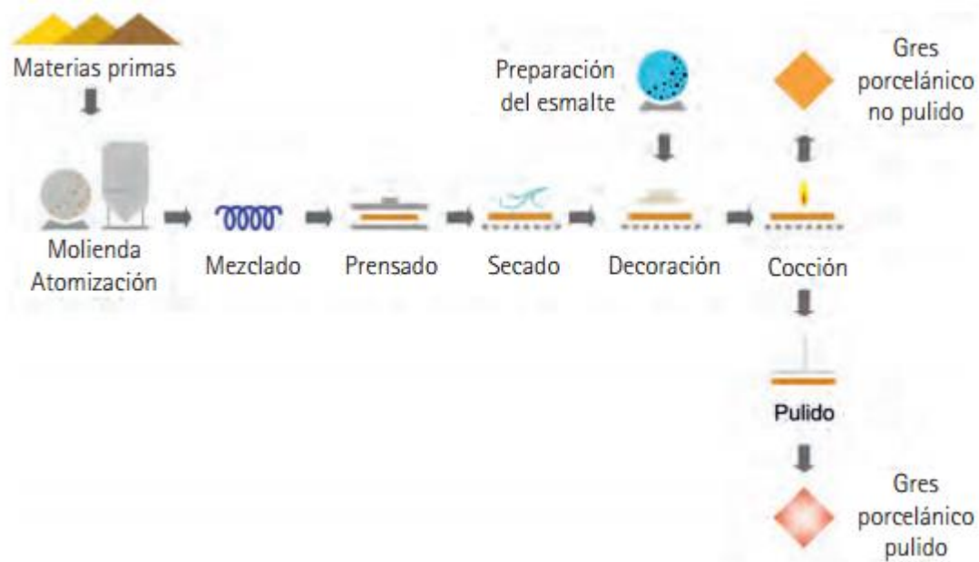
Ilustración 16 Esquema del proceso de fabricación de gres porcelánico (Fuente: Monfort, 2011)
