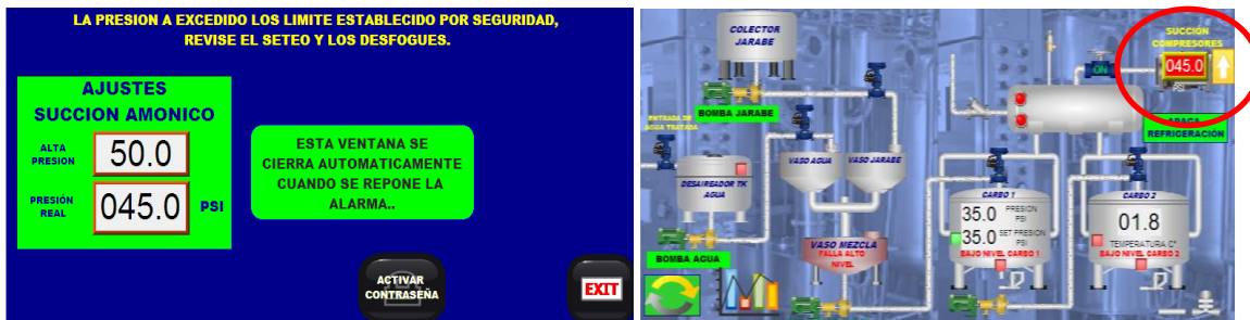
Figura 37. Falla por alta succión de amoniaco. Fuente: Elaboración propia
