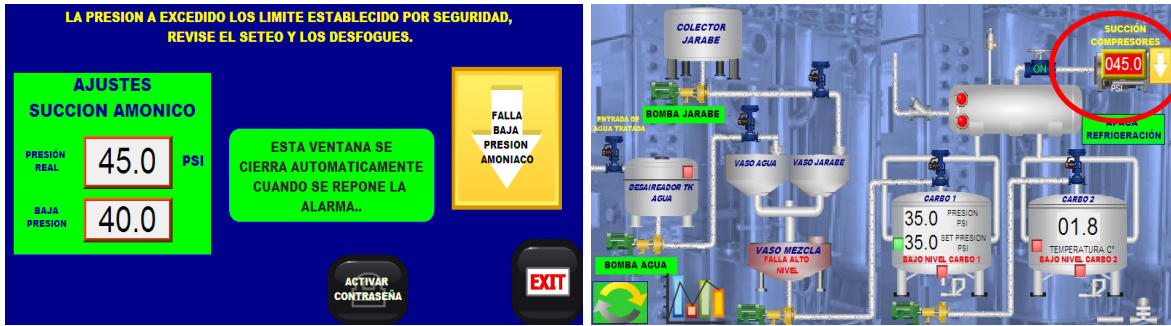
Figura 38. Falla por baja succión de amoniaco. Fuente: Elaboración propia
