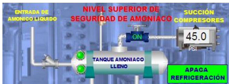
Figura 32. Sistema de refrigeración con falla. Fuente: Elaboración propia
