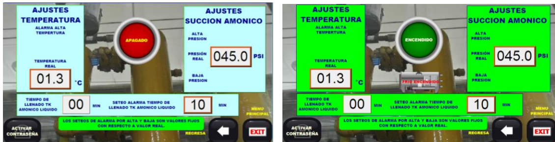
Figura 23. Encendido del sistema de Frio. Fuente: Elaboración propia
