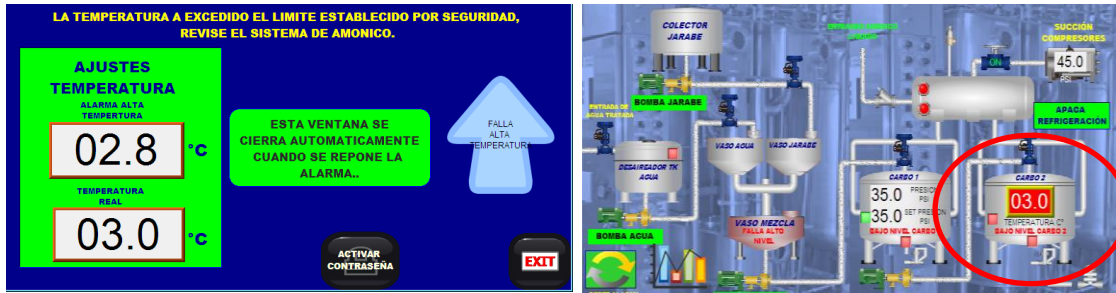
Figura 34 Falla por alta temperatura y alta presión de CO 2 . Fuente: Elaboración propia
