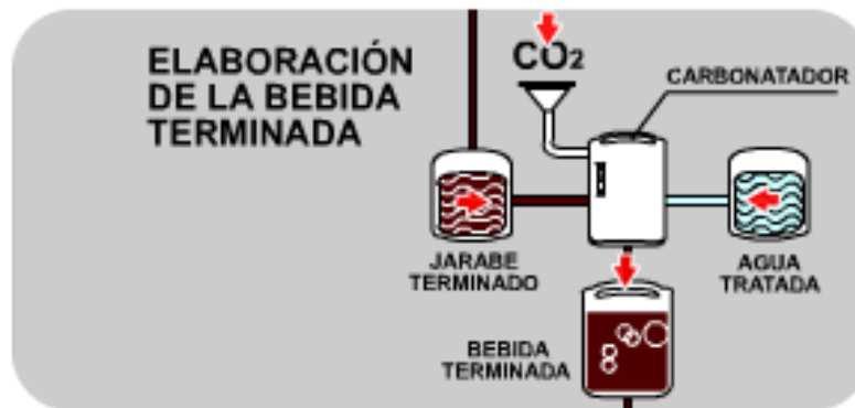
Figura 1. Proceso del carboenfriador. Fuente: Elaboración propia
