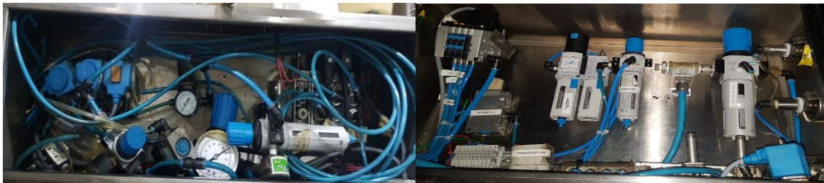
Figura 11. Antiguo juego de válvulas neumáticas VS Nuevo juego de válvulas. Fuente: Elaboración propia
