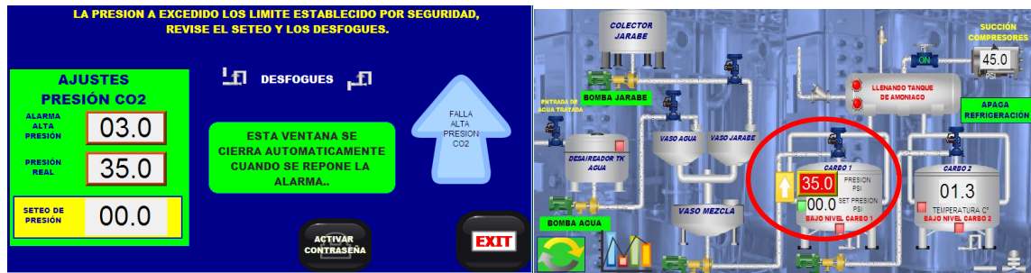
Figura 36. Tolerancia de la alarma de presión. Fuente: Elaboración propia
