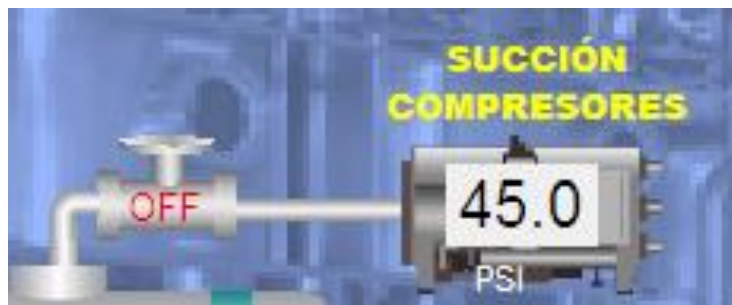
Figura 18. Presión de succión en los compresores. Fuente: Elaboración propia
