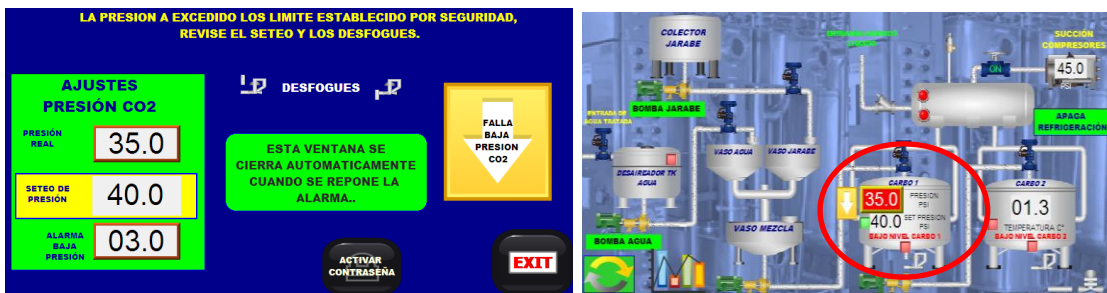
Figura 35. Falla por baja presión de CO 2 . Fuente: Elaboración propia
