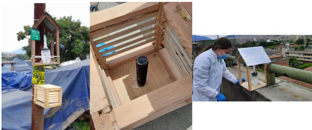
Figura 11. Proceso de instalación y recolección de captadores.
