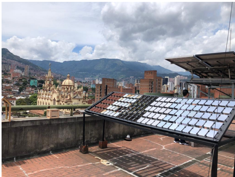
Figura 19. Bastidor para exposición en campo de placas metálicas: Sitio 1.
