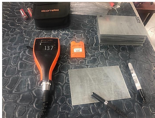
Figura 3. Medidor de espesor utilizado para las muestras de acero galvanizado.
