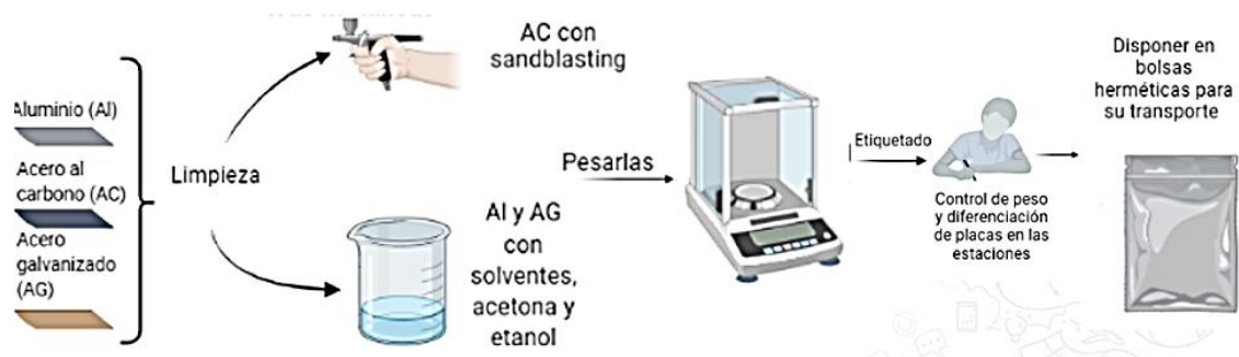
Figura 22. Preparación de muestras antes de la exposición al ambiente.
