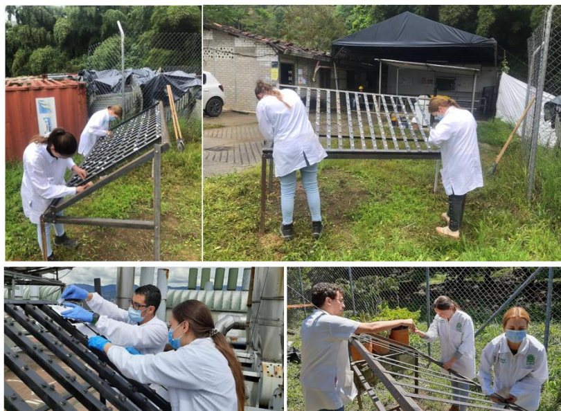
Figura 23. Instalación de estaciones en cada uno de los sitios de exposición.
