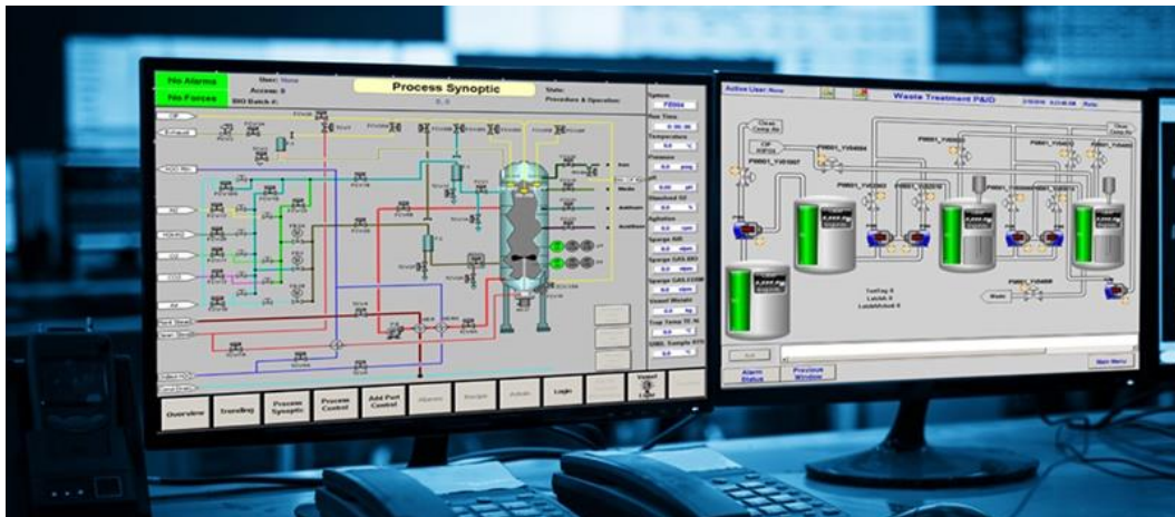
Imagen3. Interfaz de monitoreo de un sistema SCADA.
