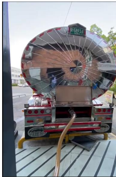
Imagen 4. Descarga de grasa vegetal en el sistema de recepción. (Fuente: Elaboración propia)
