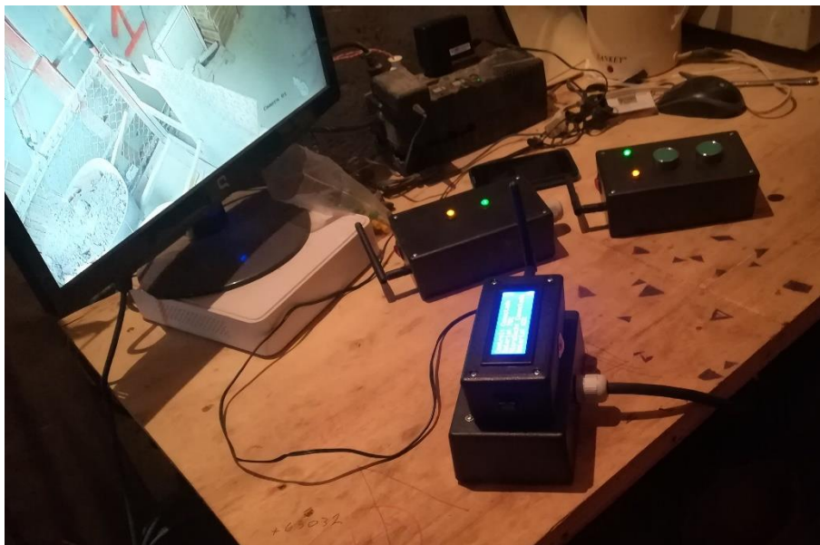
Figura 28: prueba del controlador 2 para la emisión y recepción de datos. (Propia)
