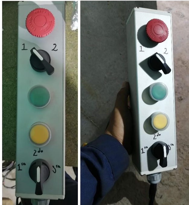
Figura 24: botonera de accionamiento para manejo de velocidades y posiciones de manera manual y automática. (Propia).
