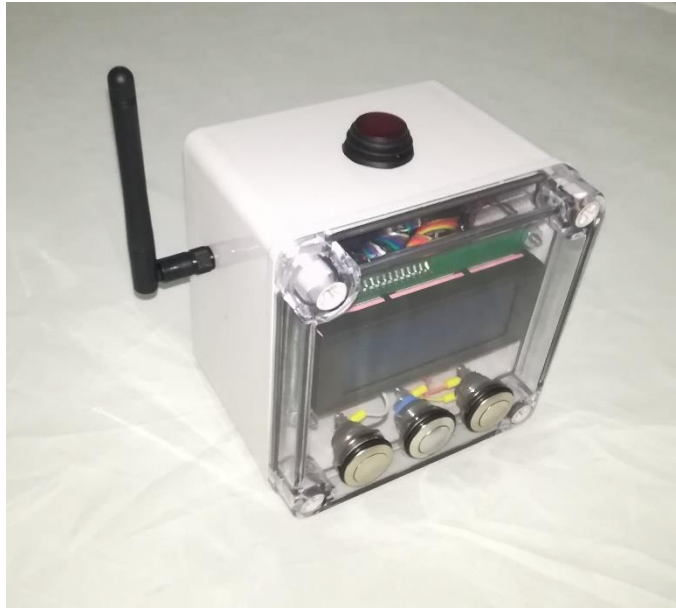
Figura 25: controlador 1, principal encargado del sistema de control. (Propia)
