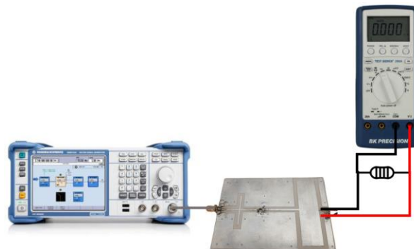
Figura 3-8: Montaje de verificación del funcionamiento del rectificador con conexión directa.
